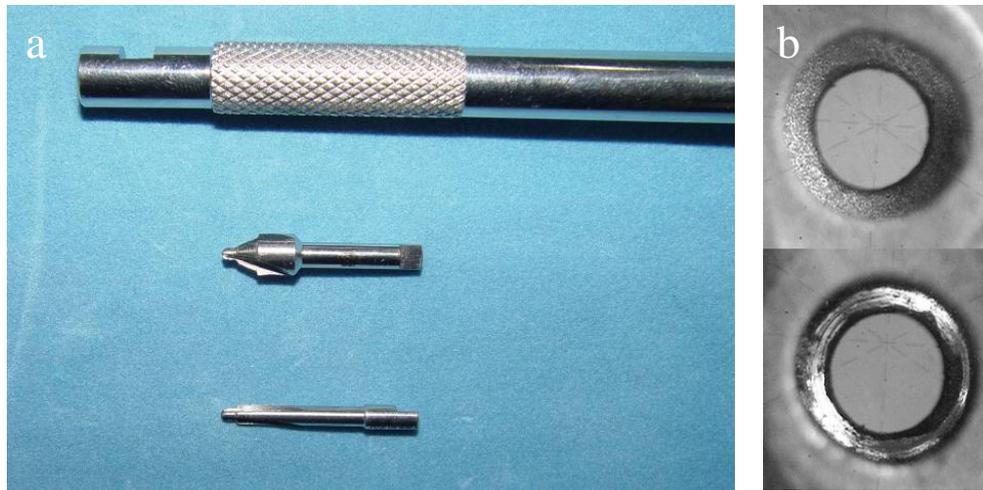
**Figura 6.** (a) Instrumentos para retificação de cilindros fundidos (Conexão), observa-se o cabo universal contido no sistema (acima), a ponta para retificação da borda dos cilindros (meio) e ponta para retificação da base de assentamento do parafuso (abaixo). (b) Fotomicrografia (50×) mostrando o aspecto da base de assentamento do parafuso antes da retificação (acima) e após retificação (abaixo).
