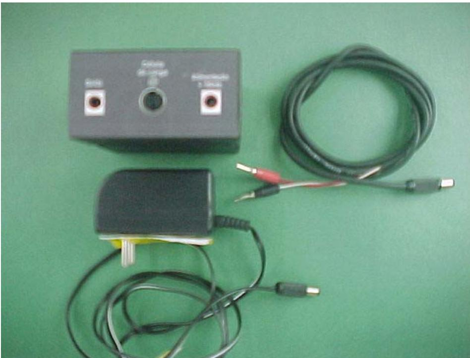
**Fig. 10b - Condicionador para célula de carga C-500 da DataHominis Tecnologia Ltda. (vista posterior).**
