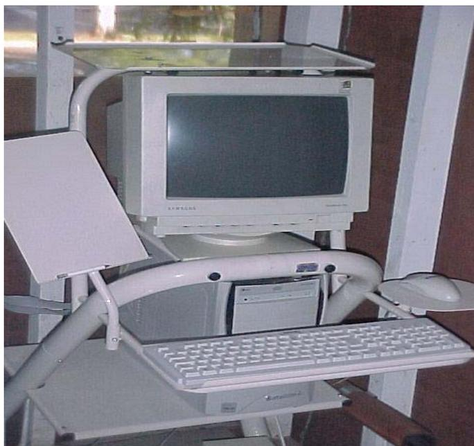
**Fig. 2- Computador Pentium III Intel 650 MHz, com HD de 10 GB e memória RAM de 128 MB.**
