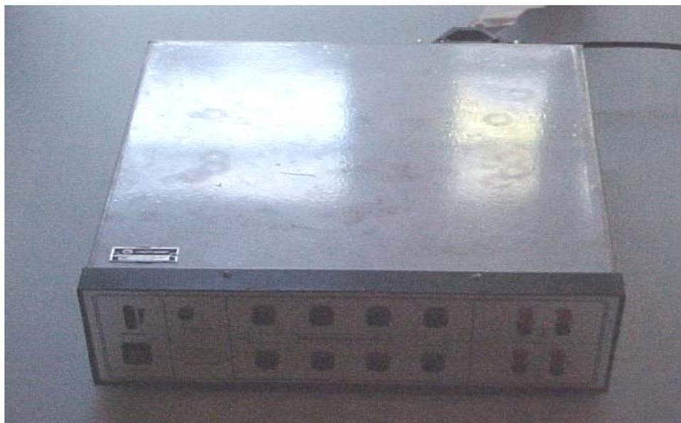
**Fig. 1- Módulo de aquisição de sinais biológicos da marca Myosystem - Br1 (Fabricante Prosecom Ltda – Uberlândia/MG)**
