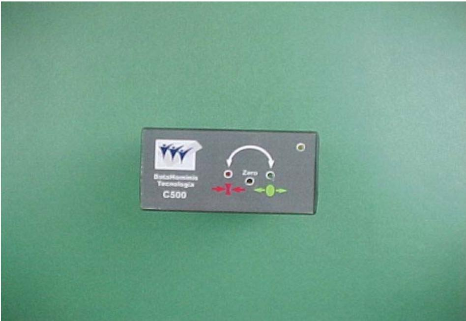
**Fig. 10a - Condicionador para célula de carga C-500 da DataHominis Tecnologia Ltda. (vista anterior).**
