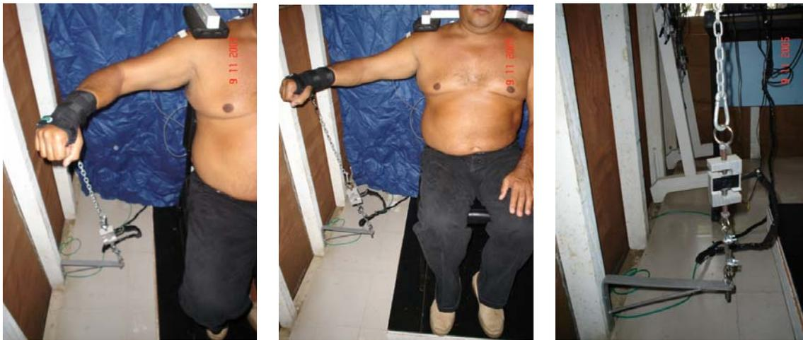
**Fig. 11- Posicionamento do voluntário durante a coleta e fixação da célula de carga.**
