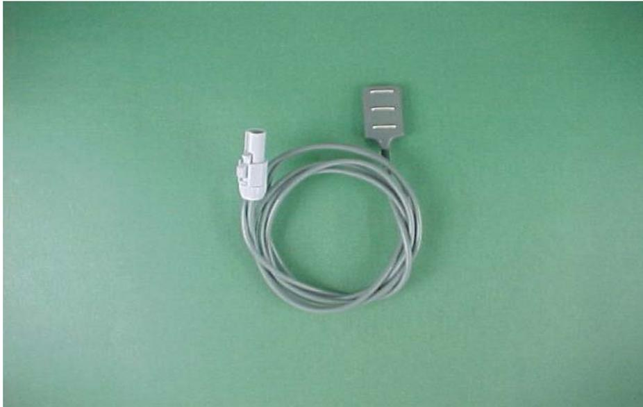
**Fig.- 3** Eletrodos de superfície duplo diferencial da DataHominis Tecnologia Ltda. com revestimento de prata pura, de dimensões 2,8 x 1,7 x 0,6 cm e com a distância de 1 cm entre as barras de captação.
