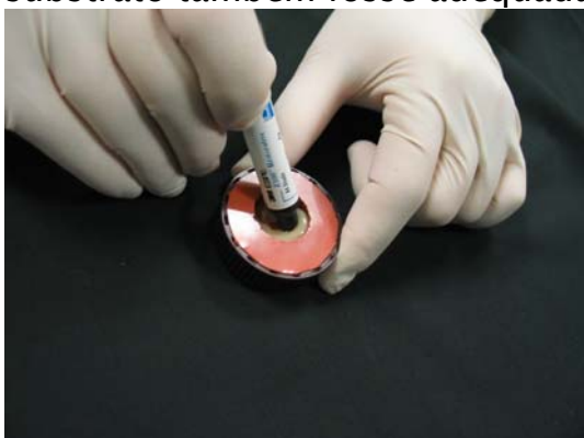
Figura 5. Matriz de silicone sendo parcialmente preenchida com compósito
