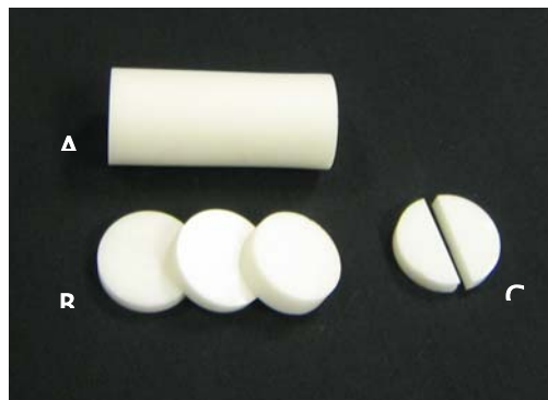
Figura 4. Cerâmica de dióxido de zircônio em diferentes etapas de corte
