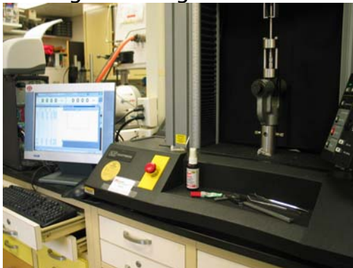
Figura 13. Máquina de ensaios preparada para o ensaio de micro-tração
