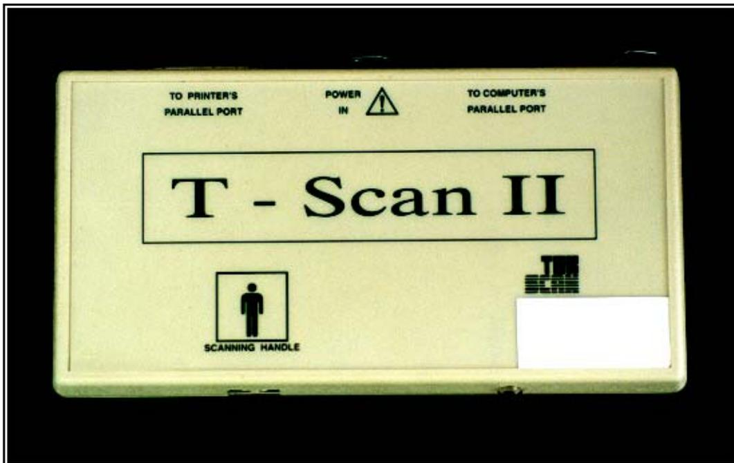
**Figura 5** – Unidade do sistema do T-Scan II. Responsável pela decodificação dos dados registrados pelo sensor durante o registro dos contatos oclusais.
