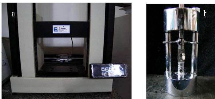
Figuras 9 (a e b)- Teste de resistência de união: a) Máquina de Ensaio universal; b) Aparato onde se fixava o *hourglass* para o ensaio de microtração.
