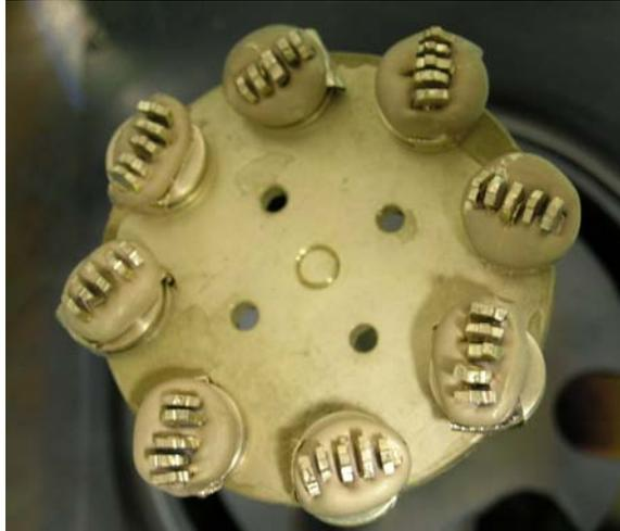
Figura 10- Metalização dos padrões de fratura. Observe que, de cada grupo, foram examinadas cinco fatias fraturadas após o teste de microtração.
