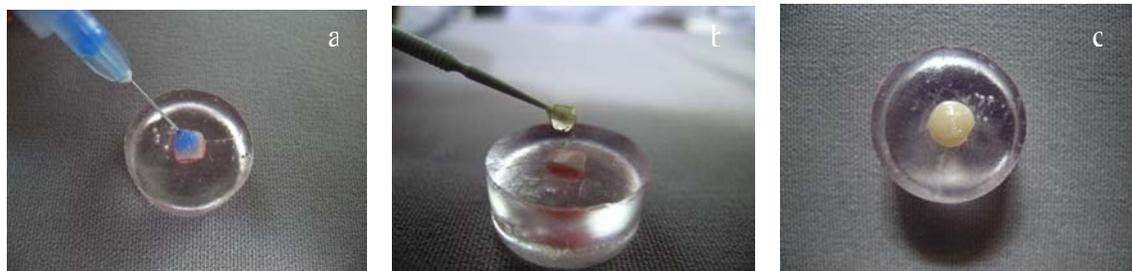
Figura 7 (a, b e c) - Procedimento restaurador: a) condicionamento ácido, por 15 segundos; b) aplicação do sistema adesivo, de acordo com as instruções do fabricante; c) construção do bloco de resina composta TPH, com aproximadamente 4mm de altura, utilizando-se a técnica incremental horizontal.
