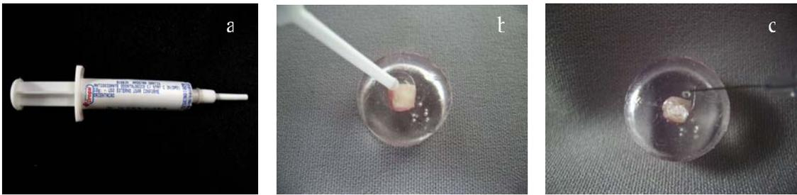
Figura 5 (a, b e c) - Aplicação do agente antioxidante a) seringa contendo o gel de ascorbato de sódio estabilizado a 3%; b) aplicação do gel antioxidante sobre bloco de dente embutido; c) aplicação de 0,02ml de saliva artificial.
