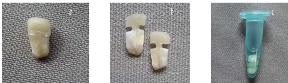
Figura 8 (a, b e c) - Obtenção dos *hourglass*: a) Bloco dente/resina, obtido após desinclusão; b) Obtenção de 2 *hourglass* por bloco; c) armazenamento dos *hourglass* em *ependorf* contendo água destilada deionizada.
