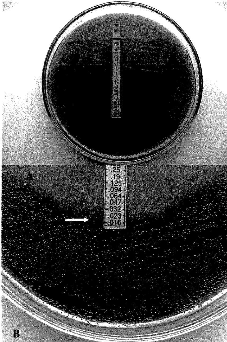
FIGURA 10- Placa utilizada na avaliação do *E-test*. A. Placa com crescimento bacteriano (*Prevotella intermedia*) e a fita de *E-test* (eritromicina); B. Aumento da figura 10A, mostrando com a seta, o ponto de intersecção entre o halo de completa inibição bacteriana e a fita de *E-test*.
