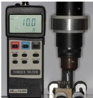
**Figura 14.** Torquímetro digital acoplado no dispositivo.
