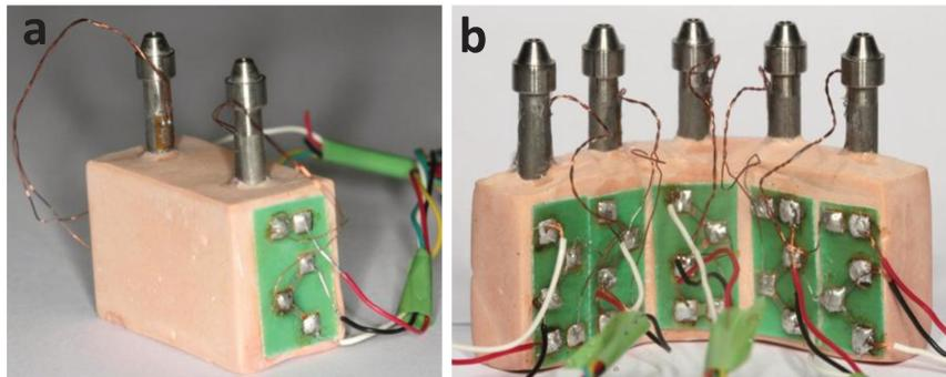
**Figura 12.** Montagem dos fios em 1/4 de ponte. a) PPF; b) PTF.
