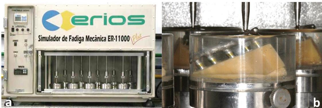
**Figura 16.** a) Simulador de fadiga mecânica (ERIOS, modelo ER – 11000 – Plus); b) Modelo de trabalho imerso em saliva artificial sob simulação mastigatória.
