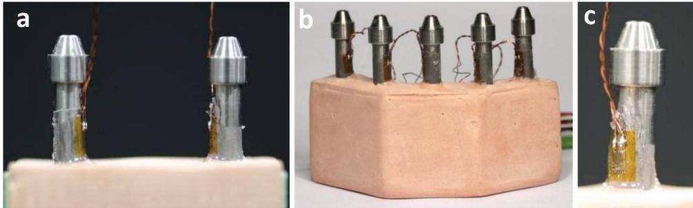
**Figura 11.** *Strain gauges* posicionados após sua colagem. a) PPF; b) PTF; c) Vista aproximada.
