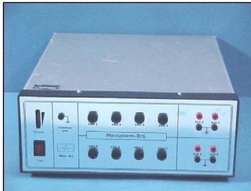
Figura 17 – Módulo condicionador de sinais Myosystem I (DataHominis Ltda)
