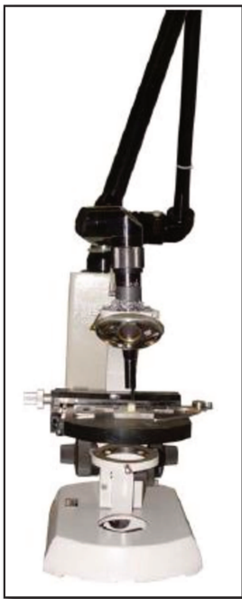
Fig. Laser de CO 2 acoplado à base adaptada de microscópio para varredura da área de esmalte
