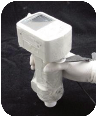
Figura 6 – Espectrofotômetro CM-700d (Minolta, Corp., Ramsey, NJ, USA) utilizado para o teste de Amarelamento.
