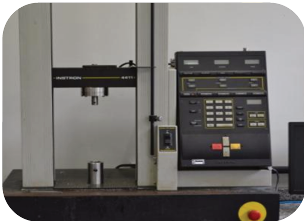
Figura 4 – Máquina de Ensaio Universal Instron, utilizado para os testes de Resistência à Flexão e Módulo de Elasticidade
