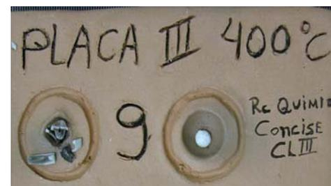
Figuras 17 – Alterações de cores da resina composta Concise e aspecto calcinado a 400°C.
