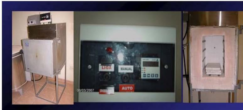
Figura 4 – Forno utilizado para queima das placas.
