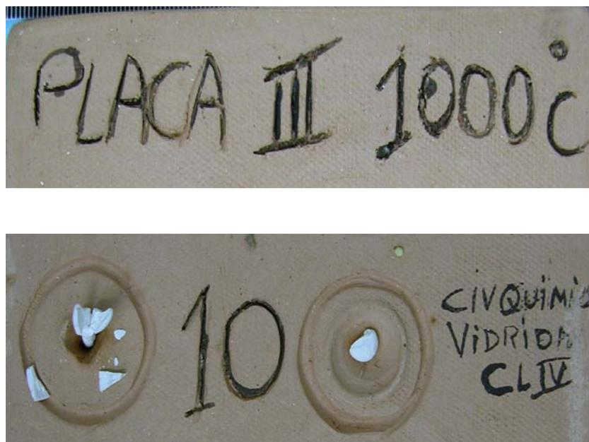
Figura 19-Aspecto calcinado do Ionômero de Vidro Vidrion
