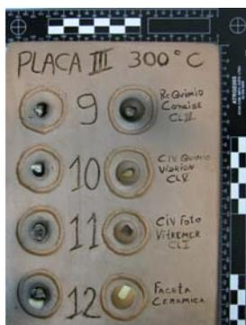
Figura 3 – Régua milimétrica utilizada em trabalhos periciais abrangendo dois lados da placa para queima.
