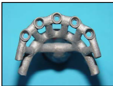
Figura 6 - Infra-estrutura desincluída e jateada.
