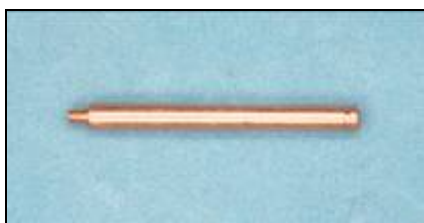
Figura 16 – Peça em cobre utilizada para eletroerosão da base de apoio do parafuso protético.
