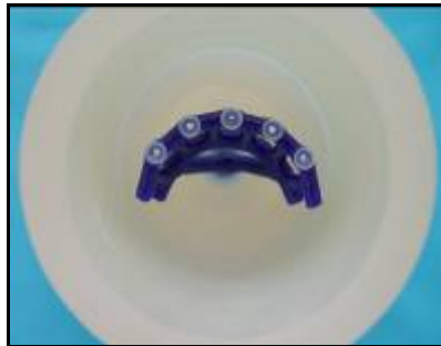
Figura 5 - Padrão em cera na base formadora de cadinho do anel de inclusão.
