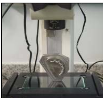
Figura 10 - Matriz e base metálicas sobre a platina do microscópio para leitura dos desajustes marginais.
