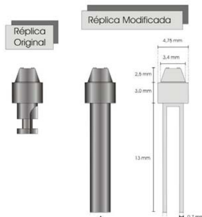
Figura 11 – Desenho esquemático de um abutment com medidas modificadas visando à captação de deformações.
