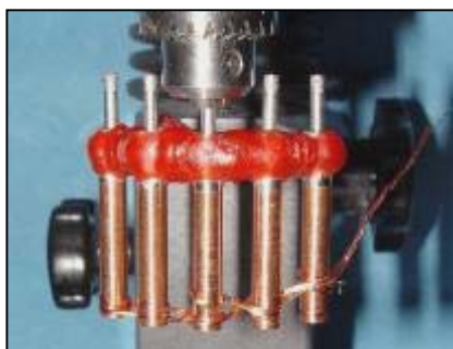
Figura 19 - Análogos de cobre dos abutments adaptados aos transferentes do jig e envolvidos com fio condutores de eletricidade.
