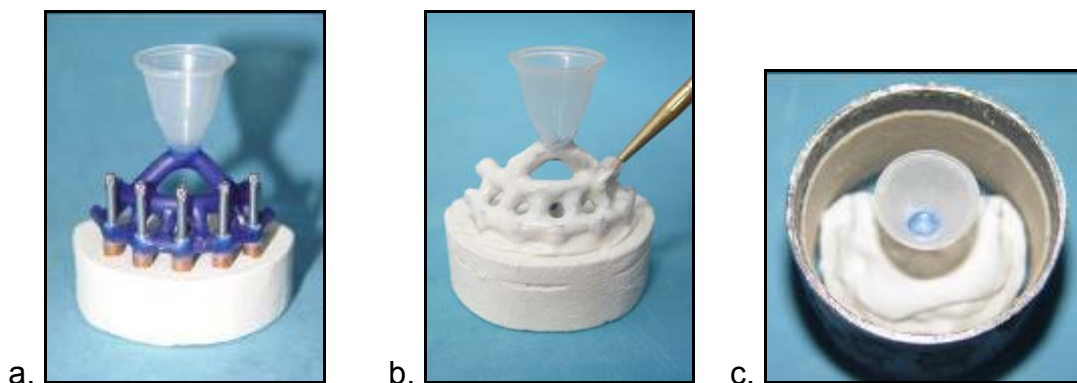
Figura 8 – a. Padrão em cera com arranjo de condutos para fundição unidos à base formadora de cadinho. b. Camada de revestimento depositada sobre o padrão. c. Anel metálico revestido internamente com amianto.
