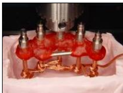
Figura 17 – Peças envolvidas com fios de cobre centralizadas dentro do molde de silicone.
