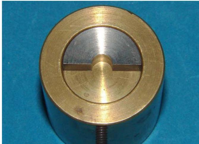
**Figura 4.1** – Matriz metálica bipartida cilíndrica com 5mm de diâmetro e 4mm de altura.
