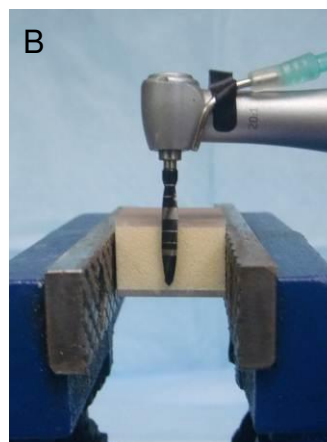
Figura 5. A- Perfuração com broca lança, 2,0 mm de diâmetro; B- Broca com marca da profundidade (11mm).
