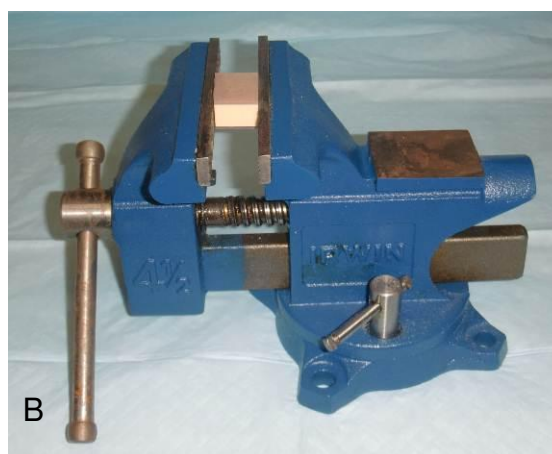
Figura 4. A- Placa sendo cortada por serra diamantada; B- Bloco posicionado e fixado em morsa para perfuração e instalação dos implantes.
