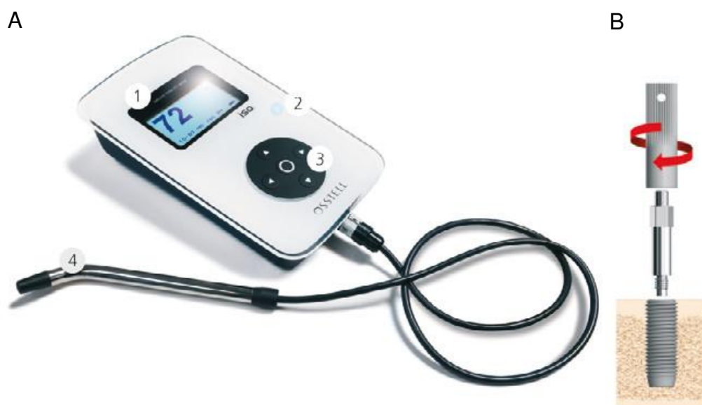
Figura 8. A - Osstell – 1. Visor, 2- LED indicador de alimentação azul, 3- Teclas de funcionamento, 4- Sonda do Osstell ISQ; B – SmartPeg.
