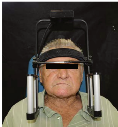
Figura 2 – Dispositivo sensor magnético do Cinesiógrafo (JT-3D; BioResearch, Milwaukee, WI, EUA) acoplado à cabeça do voluntário - capta a amplitude de movimento da mandíbula e posteriormente os movimentos durante a mastigação de Optocal por 40 ciclos mastigatórios.
