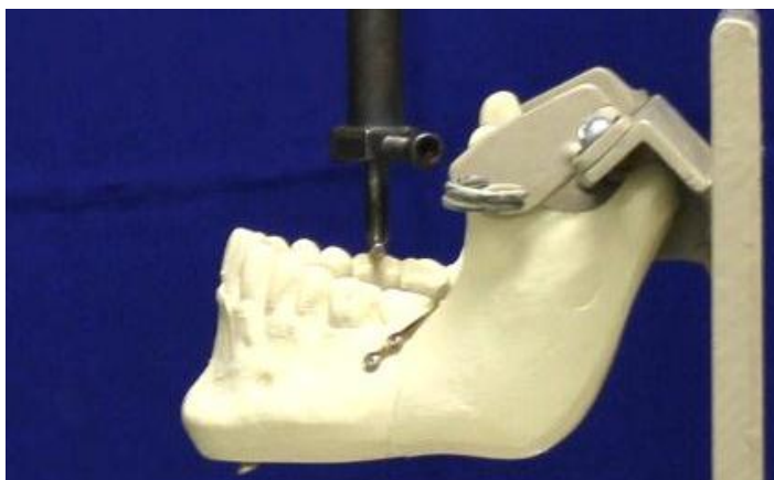
Figura 10 – Aplicação de carga em molar contralateral (MC).
