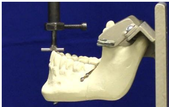
Figura 12 – Aplicação de carga entre incisivos (I).
