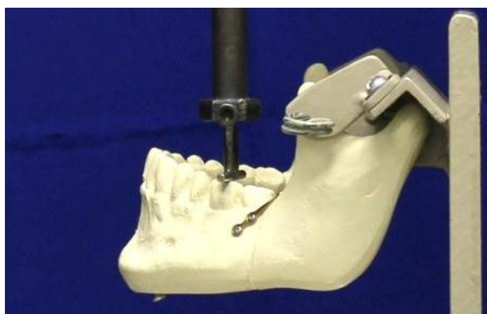
Figura 11 – Aplicação de carga em molar ipsilateral (MI).
