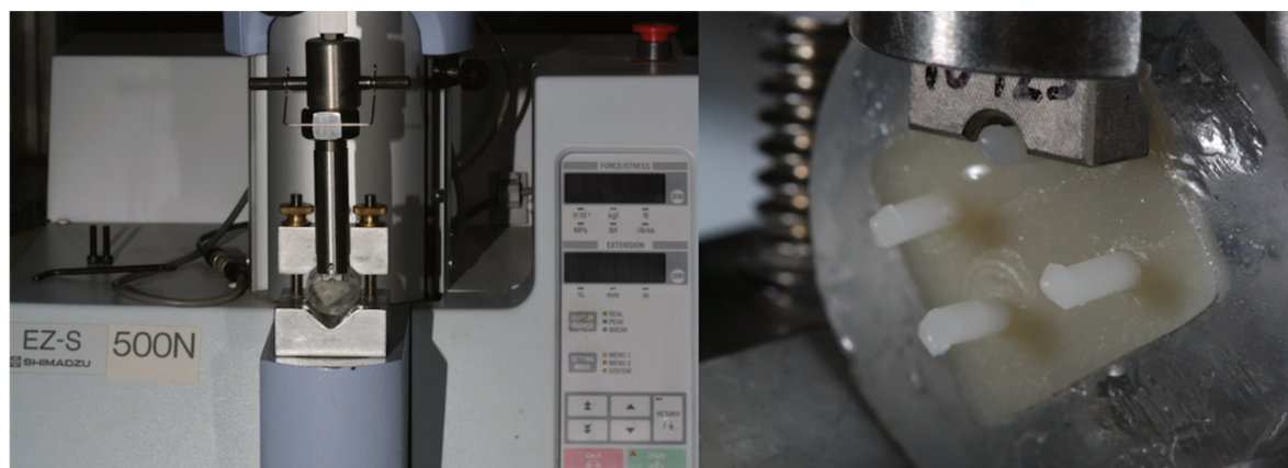
Figura 2: Máquina de ensaio Universal (EZ-S TEST), ensaio de cisalhamento
