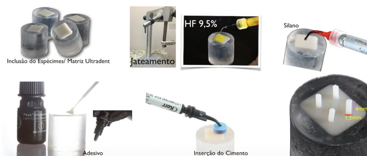
Figura 1: Sequência de obtenção dos corpos de prova
