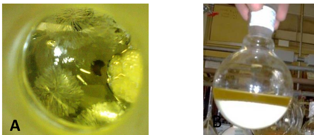
Figura 16: (A) Cristais obtidos após concentração da fração P1, obtida no fracionamento do EBD proveniente dos frutos da Pterodonpubescens ; (B) recristalização em hexano.
