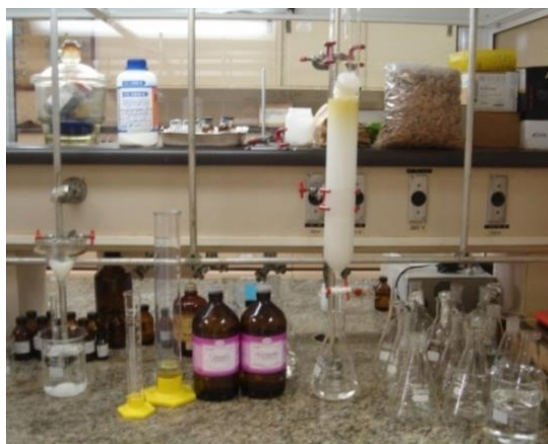
Figura 8: Imagem do sistema de cromatografia em coluna clássica
