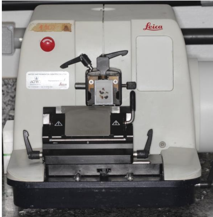
Figura 1. Confeção do corte histológico para preparo das lâminas. Imagem mostrando o bloco contendo o tecido incluído em parafina e posicionado no micrótomo RM 2165 (Leica Microsystems, Wetzlar, Alemanha).
