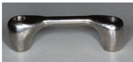
Figura 6: Infraestrutura fundida em titânio cp acabada e polida
