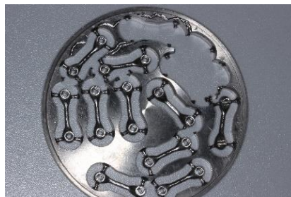
Figura 8: Barras fresadas no bloco de liga de titânio
