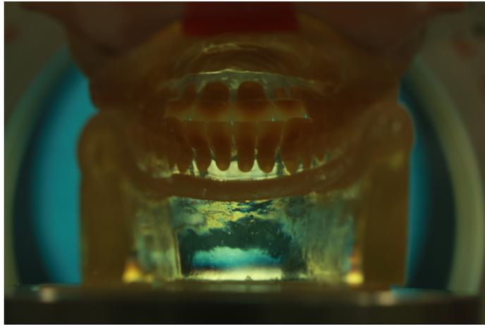
Figura 45: Modelo fotoelástico posicionado em oclusão no polariscópio circular de transmissão plana. Grupo 02. Sem carga axial.
