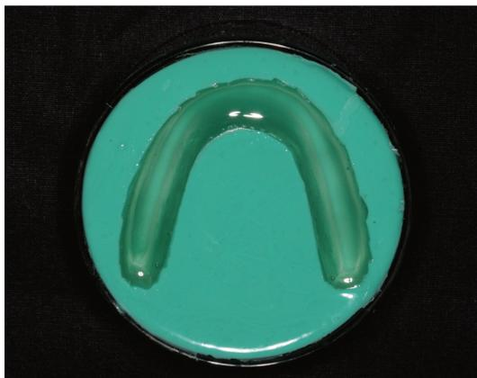
Figura 30: Vazamento do molde com resina fotoelástica.
