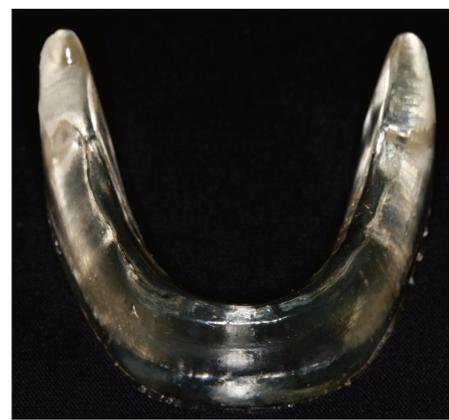
Figura 31: Modelo fotoelástico finalizado.
