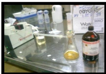
Figura 12-Filtração em coluna C18.
