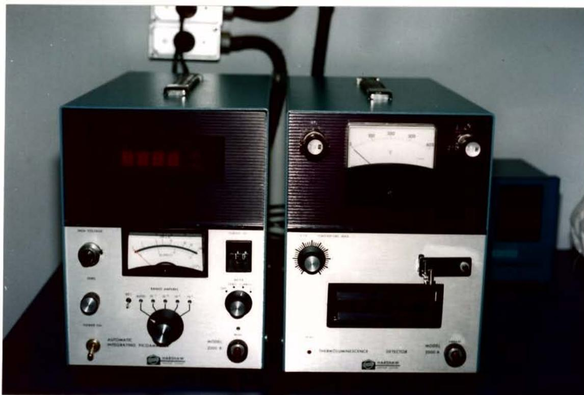
Figura n.3. Sistema HARSHAW modelo 2000A+2000B.
