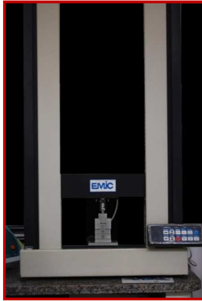
Figura 12: Corpos de prova fixados em dispositivo para o ensaio de micro-tração, adaptado à Máquina de Ensaio Universal (Emic DL 500, São José dos Pinhais, SC, Brasil).
