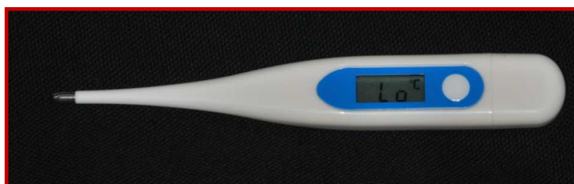
Figura 4: Termômetro digital Powerpack ET- 11 plus utilizado para verificar a temperatura do jato de ar aplicado sobre cada adesivo.
