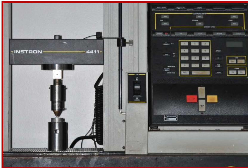
Figura 15: Máquina Universal de ensaio mecânico (INSTRON, modelo 4111, Corp., Canton, MA) com célula de carga de 50 N ( 5Kgf) utilizada para a realização dos testes de resistência à flexão e módulo de elasticidade.
