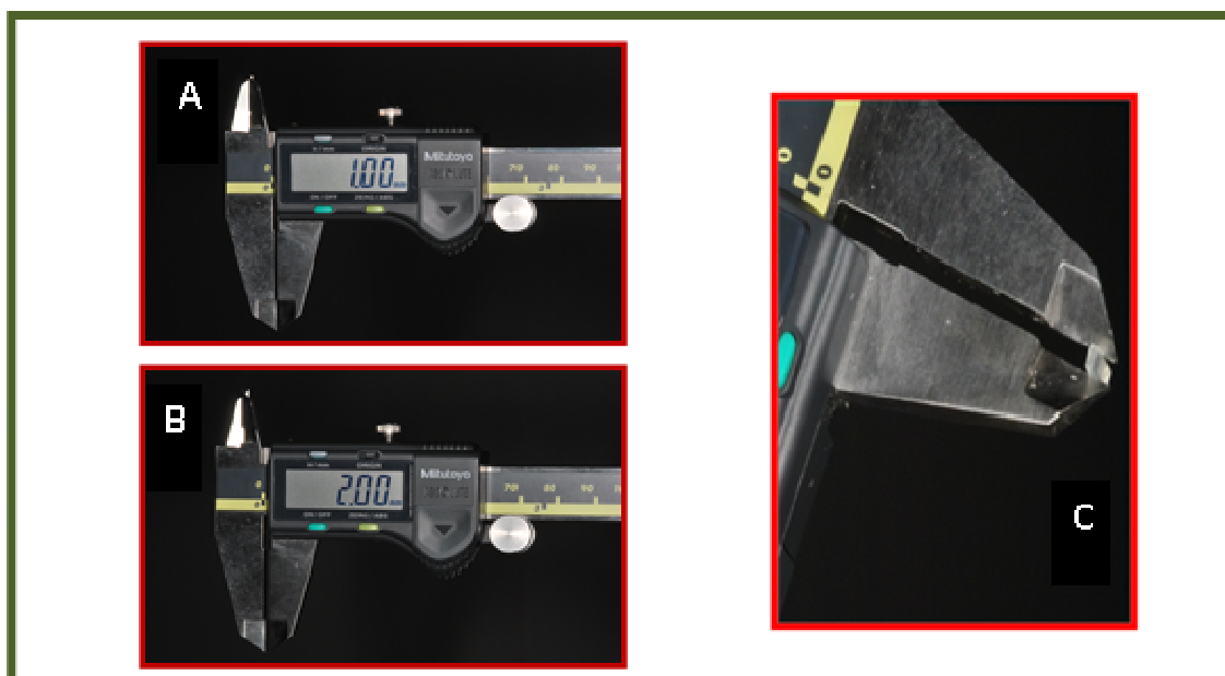
Figura 11: Medição de (A) largura ( \pm 2 mm) e (B) altura ( \pm 1 mm) das amostras utilizando paquímetro digital Absolute (Mitutoyo, Tokyo, Japan, 0.01mm accuracy); (C) aferição da amostra em maior aumento.
