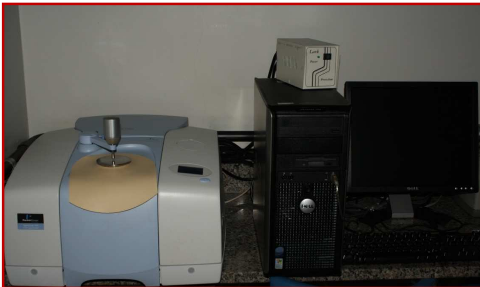
Figura 7: FTIR Spectrometer, Perkin Elmer, Waltham, MA, EUA, equipamento utilizado para análise do grau de conversão dos sistemas adesivos.
