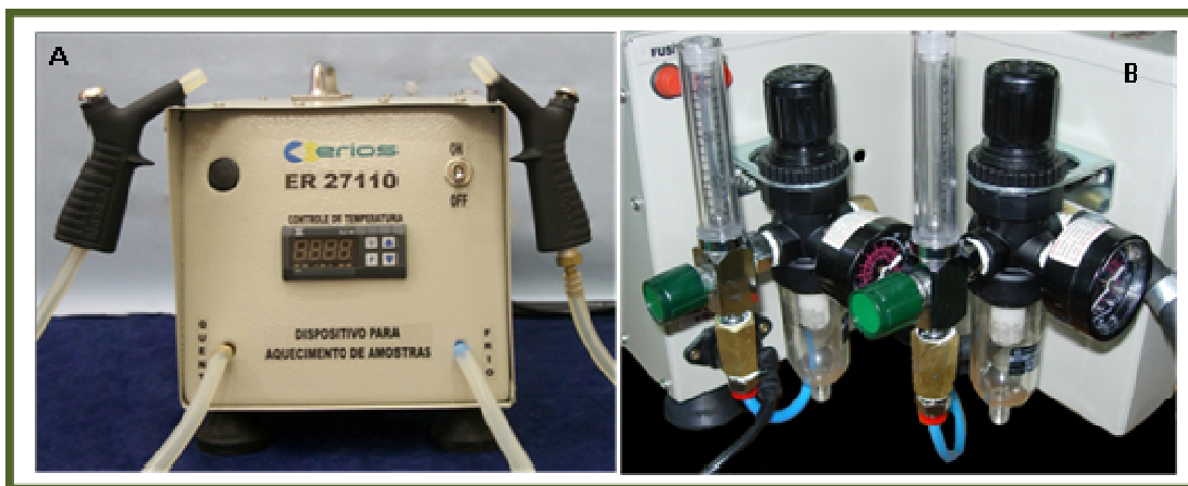
Figura3: A- Vista frontal: Dispositivo portátil para o aquecimento de ar utilizado neste estudo; B- Vista Traseira: Pressão (5psi) e vazão de ar (15 l/min) ejetadas controladas e constantes na saída do dispositivo.
