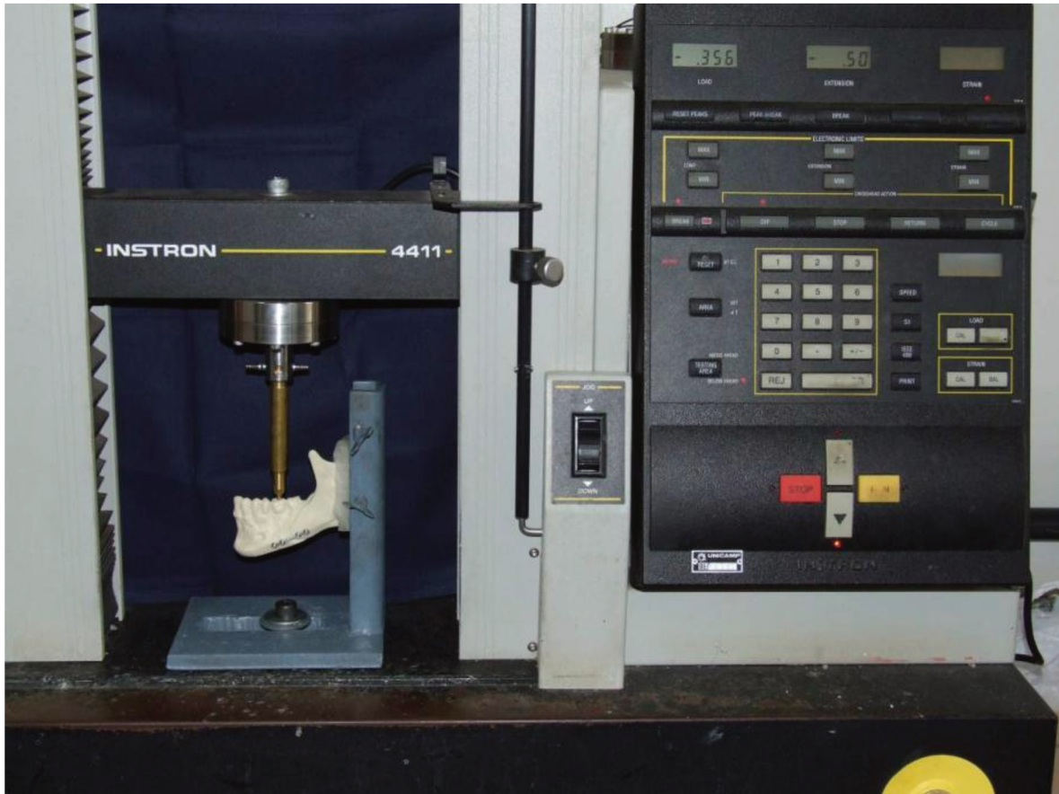
Figura 14 – Máquina de Ensaio Instron 4411 com suporte e amostra em posição
