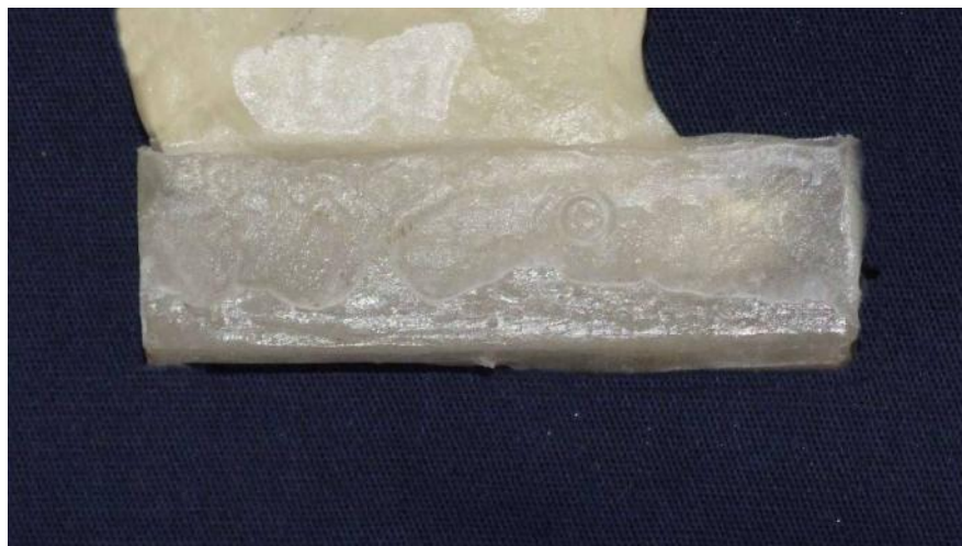
Figura 13 - Base em resina acrílica confeccionada para as hemimandíbulas nos testes mecânicos
