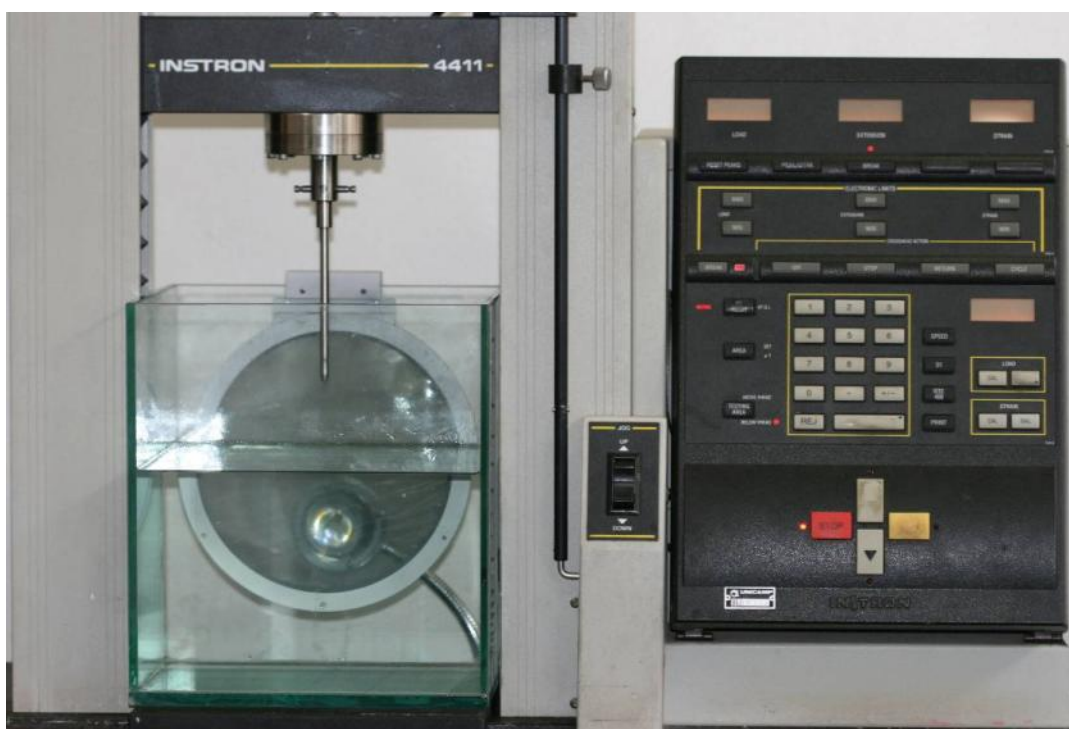
Figura 22 – Vista Frontal do Polariscópio acoplado à máquina de ensaio
