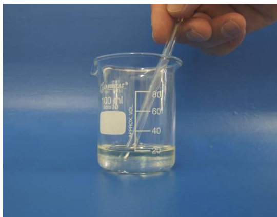
Figura 19 – Mistura da resina com o endurecedor com o auxílio de um bastão de vidro
