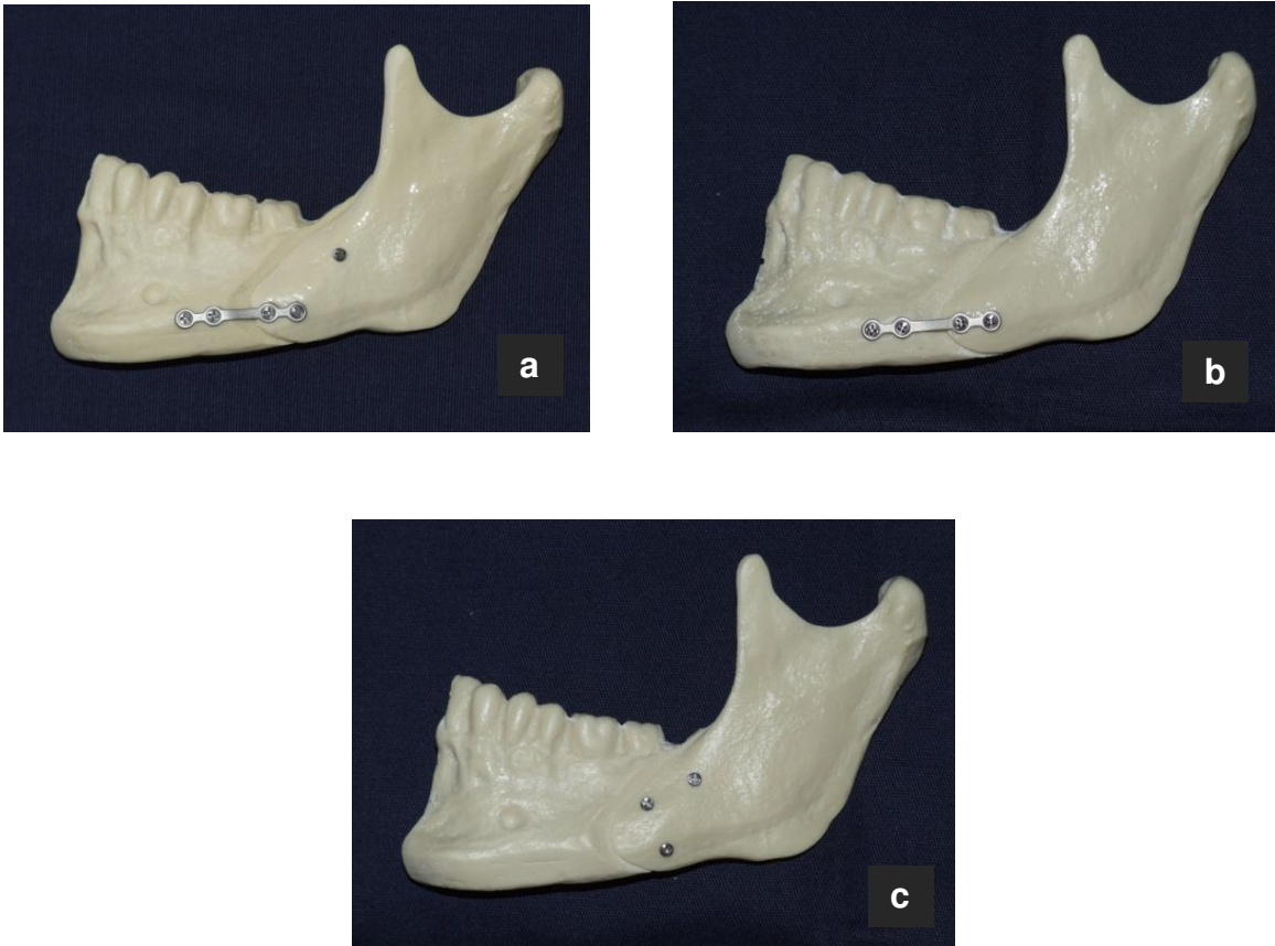
Figura 12 – Hemimandíbulas fixadas com um avanço de 5 mm: a) Hemimandíbula fixada utilizando técnica híbrida, b) Hemimandíbula fixada com miniplaca e parafusos monocorticais, c) Hemimandíbula fixada com 3 parafusos em L invertido.
