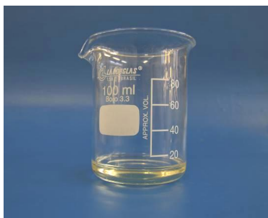
Figura 17 – Resina Araldite adicionada ao Becker
