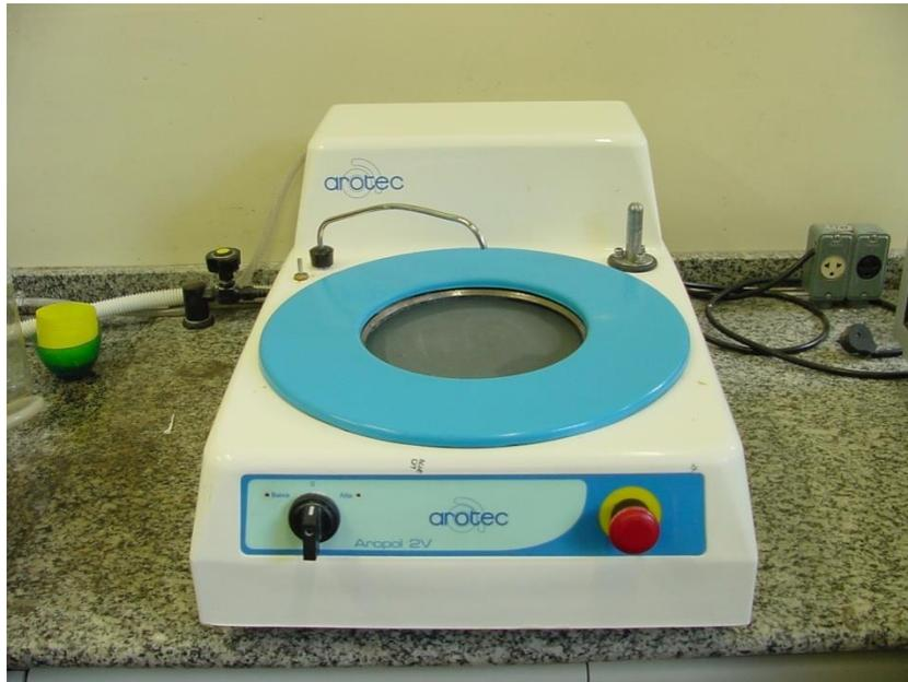
Figura 2: Politriz utilizar para desgastar esmalte dos blocos dentais
