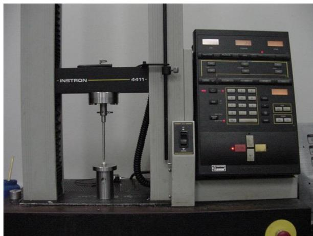
**Figura 15:** Máquina de ensaio universal Instron
