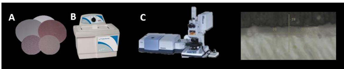
Figura 11. Análise do grau de conversão na camada híbrida. A): polimento dos palitos utilizando lixas de granulação P1200, P2000, P2500 e P4000; B) limpeza em cuba ultrassônica; (C) espectrômetro (Senterra, BrukerOptik GmbH); (D) obtenção dos espectros-raman na região de camada híbrida.
