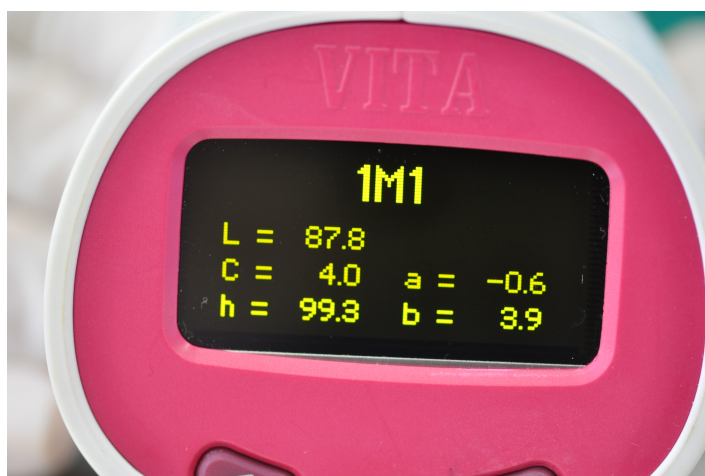
Figura 14: Avaliação objetiva. Os valores indicam: L* representa o valor do dente em uma escala de 0 (preto) a 100 (branco); (a*) e (b*) representam a sombra, em que (a*) é a medida ao longo do eixo vermelho (a* positivo) - verde (a* negativo), e (b*) é a medida ao longo do eixo amarelo (b* positivo) – azul (b* negativo).
