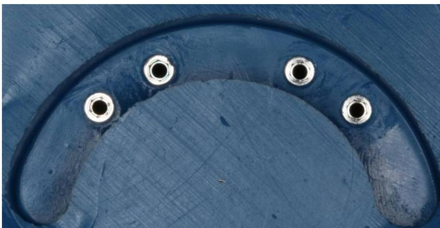
**Figura 22:** Molde em silicone após a remoção da matriz de aço.
