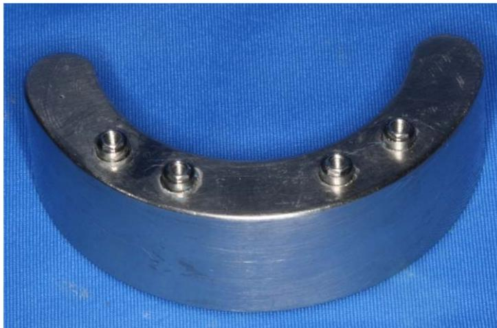
**Figura 1:** Matriz de aço com as réplicas de implantes instaladas.
