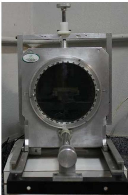
**Figura 28:** Polariscópio circular em visão frontal.
