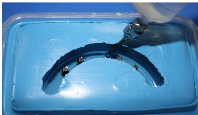
**Figura 26:** Colocação da resina fotoelástica com auxílio da seringa plástica descartável.
