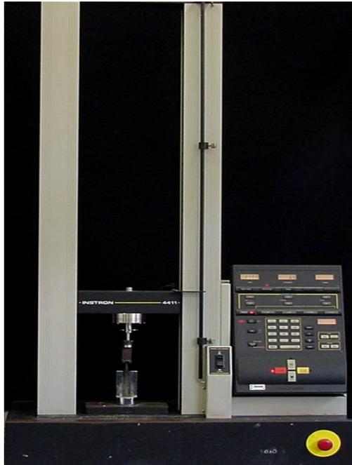
**Figura 34:** Máquina de ensaios universais Instron.
