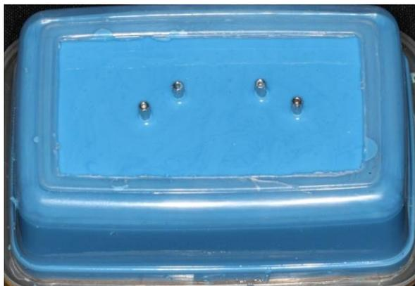
**Figura 21:** Material de moldagem depositado no recipiente plástico.
