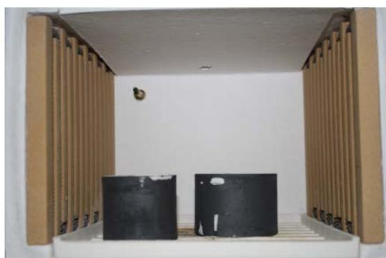
**Figura 11:** Anéis metálicos posicionados no interior do forno de fundição.
