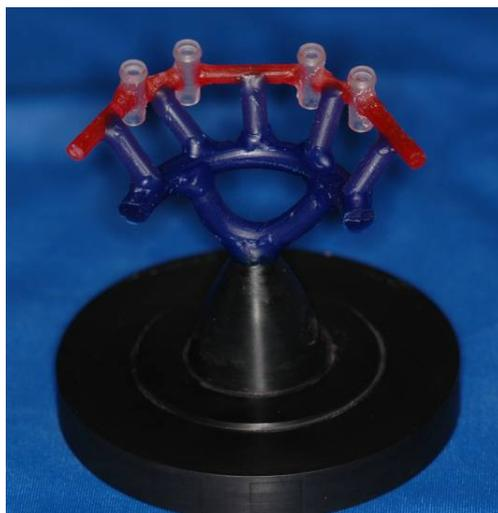
**Figura 9:** Enceramento com os condutos de alimentação unidos à base do cadinho.
