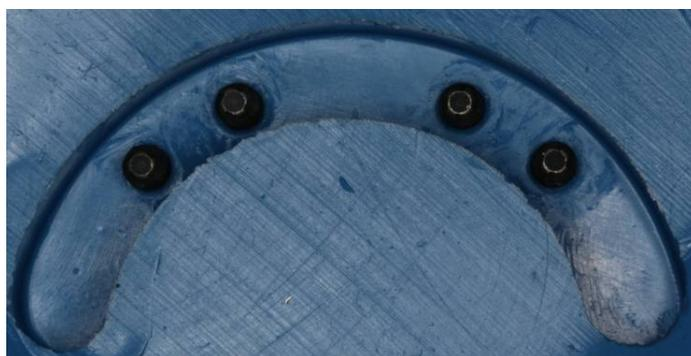
**Figura 24:** Implantes posicionados no interior do molde de silicone.
