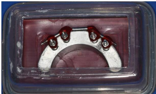
**Figura 20:** Matriz no interior do recipiente plástico para moldagem de transferência.
