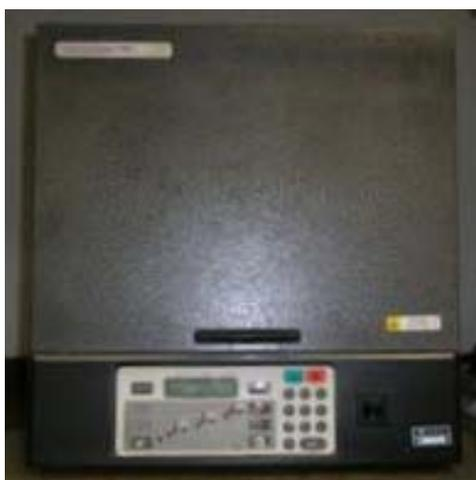
**Figura 10:** Forno de fundição.
