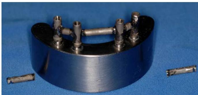
**Figura 46:** Infraestrutura soldada a TIG após realização do teste de flexão.
