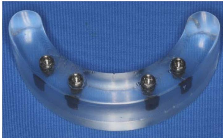
**Figura 27:** Modelo fotoelástico.
