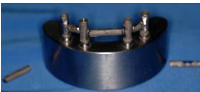
**Figura 47:** Infraestrutura soldada a Laser após realização do teste de flexão.
