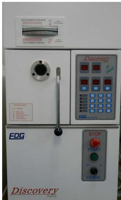
**Figura 12:** Máquina de fundição.
