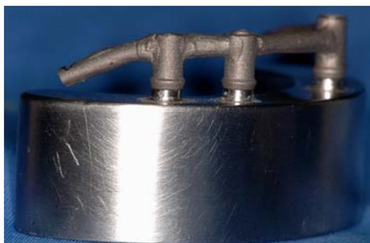
**Figura 45:** Infraestrutura em monobloco após o teste de flexão, sem ocorrer fratura do *cantilever*.
