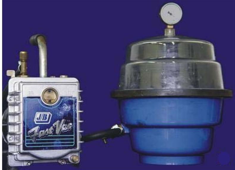
**Figura 25:** Câmara de pressão a vácuo.
