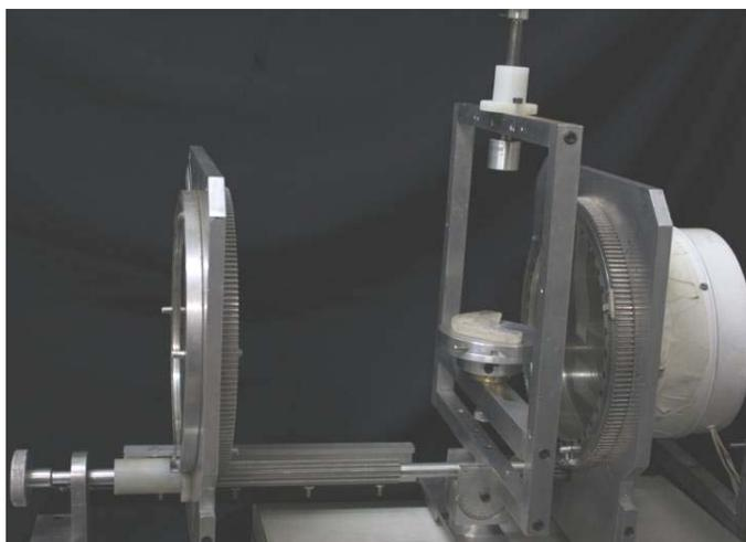
**Figura 29:** Polariscópio circular em visão lateral
