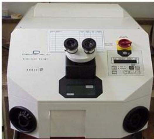
**Figura 16:** Máquina de solda a Laser.
