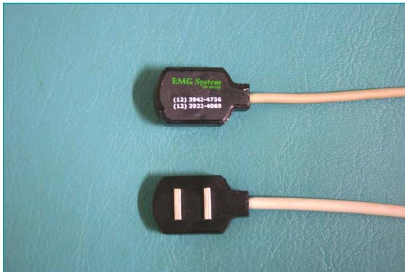
**Figura 02.** Eletrodo ativo simples diferencial da *EMG System do Brasil Ltda.*
