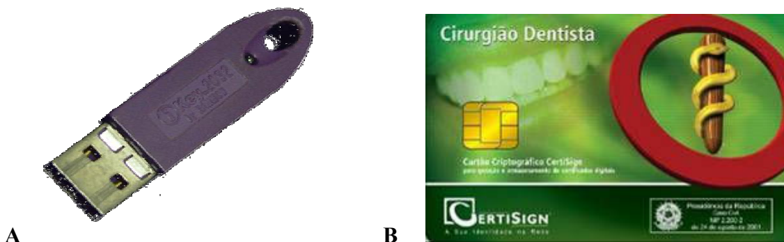
Figura 6: Dispositivos de armazenamento dos Certificados Digitais Token (A) e Smart Card (B)
