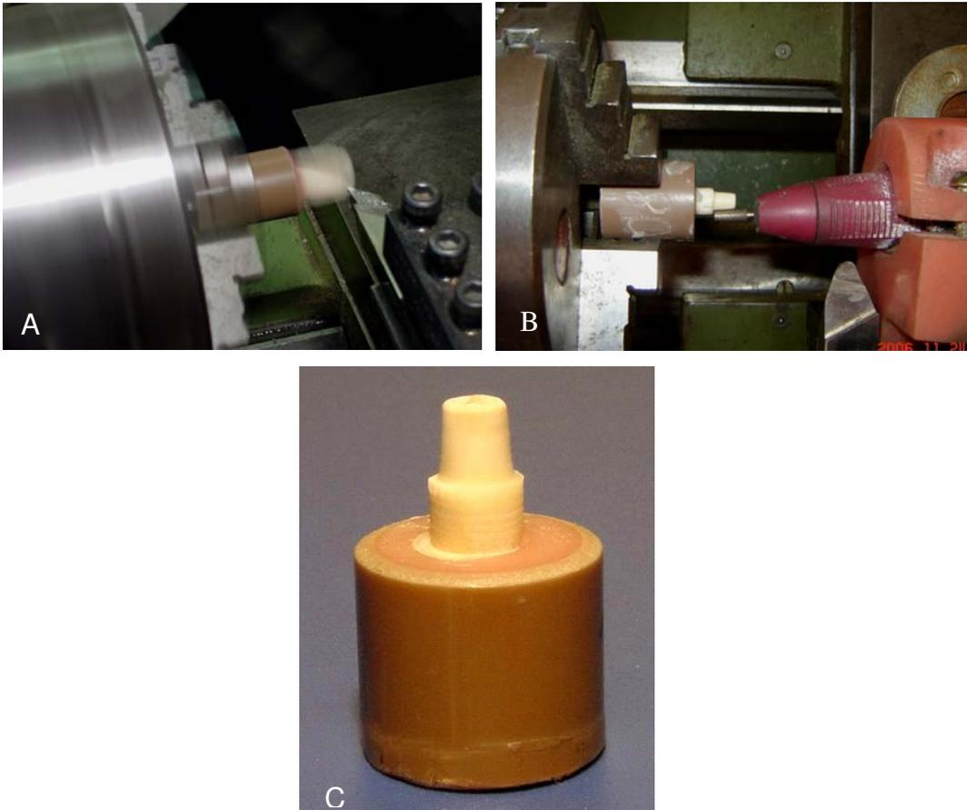
Fig. 1: A, B – Preparo do dente em torno mecânico (Nardini 300III); e C – Dente preparado.
