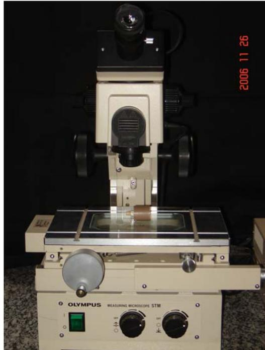
Fig 7: A – Microscópio de mensuração e corpo-de-prova posicionado no microscópio.
