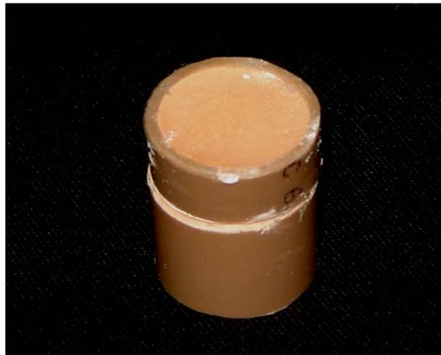
Fig 4 – Prenchimento da matriz em P.V.C. para formação da base do troquel.
