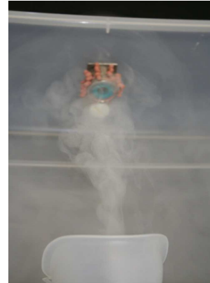
IX – Névoa sendo aplicada sobre o molde
