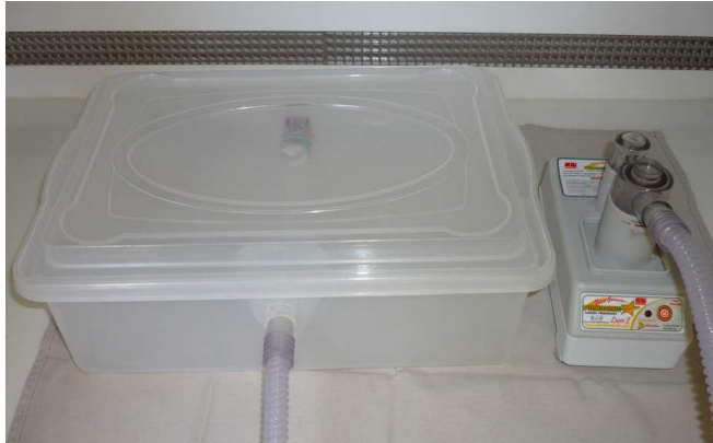
VIII – Caixa plástica transparente acoplada ao nebulizador ultrassônico
