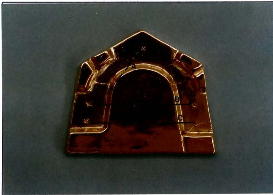
FIGURA 4.6 - Medições horizontais usadas para determinar a precisão dimensional das amostras.
