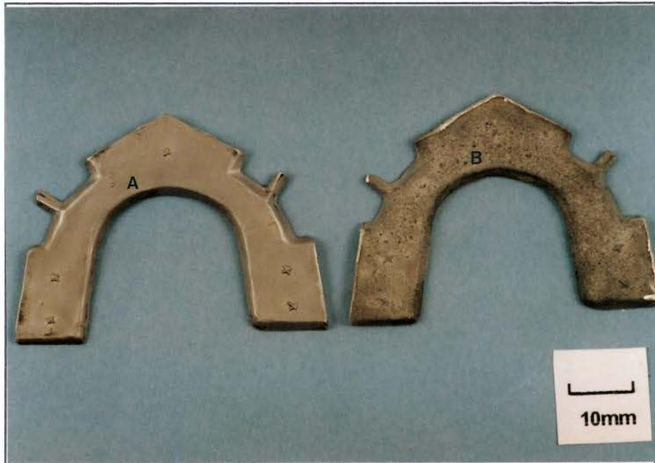
**FIGURA 5.4** - Fotografia das amostras fundidas pelas técnicas Experimental e Convencional.
