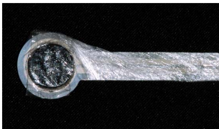
Figura 4 – Sensor (FSR N°151, Interlink Electronics Inc., Camarillo, California, USA) para mensuração da força máxima de mordida (vista superior).
