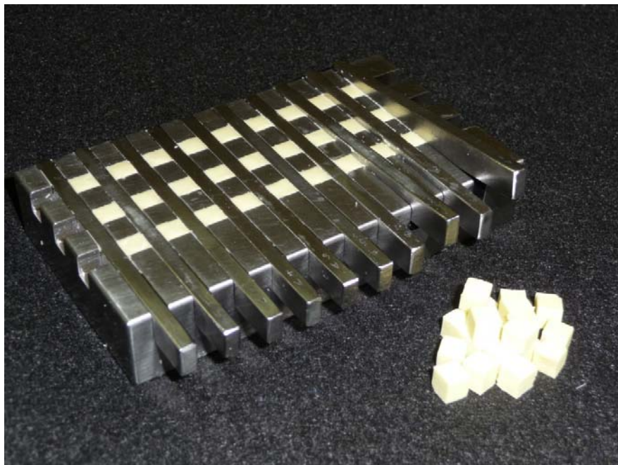
Figura 8 – Confeção de cubos de Optosil® (Heraus Kulzer, São Paulo, Brasil) com 5,6mm de aresta, utilizando-se matriz metálica.
