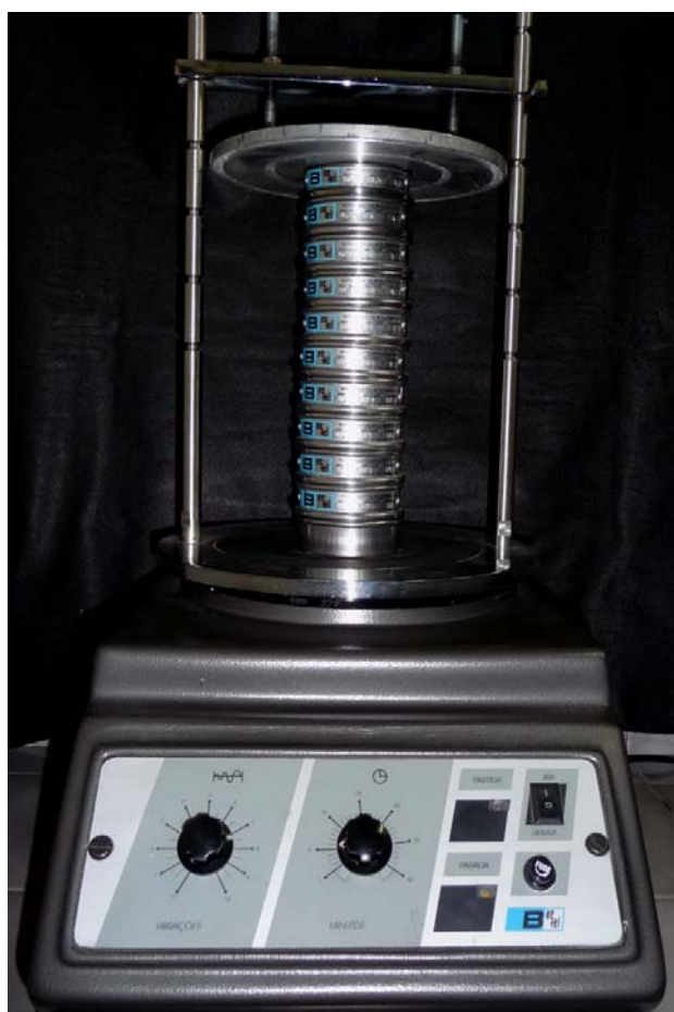
Figura 11 - Sistema de peneiras acopladas ao agitador (Bertel Indústria Metalúrgica Ltda., São Paulo, Brasil).
