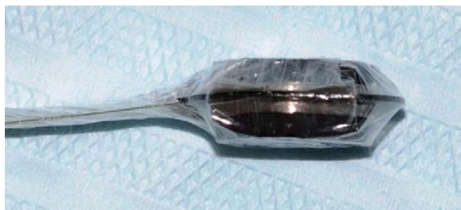
Figura 5 - Sensor (FSR N°151, Interlink Electronics Inc., Camarillo, California, USA) para mensuração da força máxima de mordida (vista lateral).
