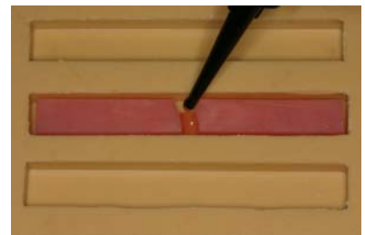
Aplicação do 1º incremento de resina
