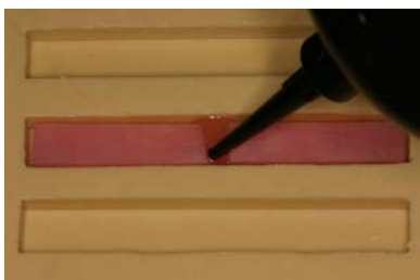
Aplicação do 2º incremento de resina
