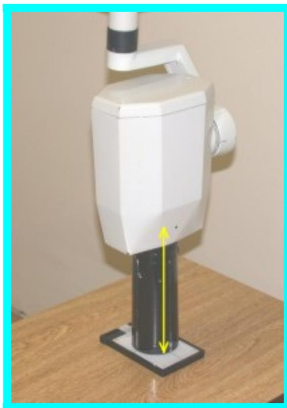
FIGURA 4 – Comprimento do localizador (ponto focal / extremidade de saída).
