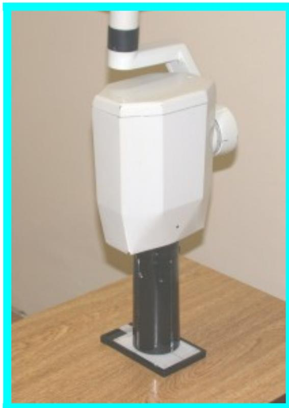
FIGURA 3 – Posicionamento do kit dosimétrico em relação ao aparelho.
