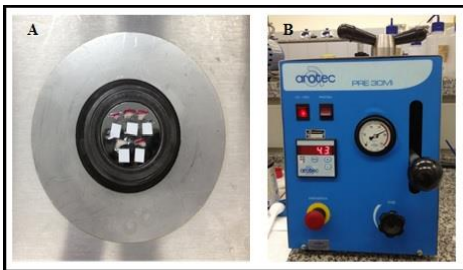
Figura 9: Para a realização da análise da microdureza longitudinal uma secção de cada bloco foi embutida na embutidora
