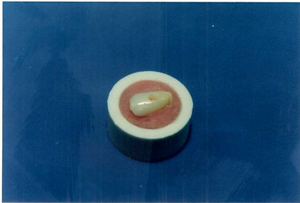
Figura 4.1 - Coroa dental fixada em anel plástico com resina acrí l ica ativada quimicamente (X 2 linear).
