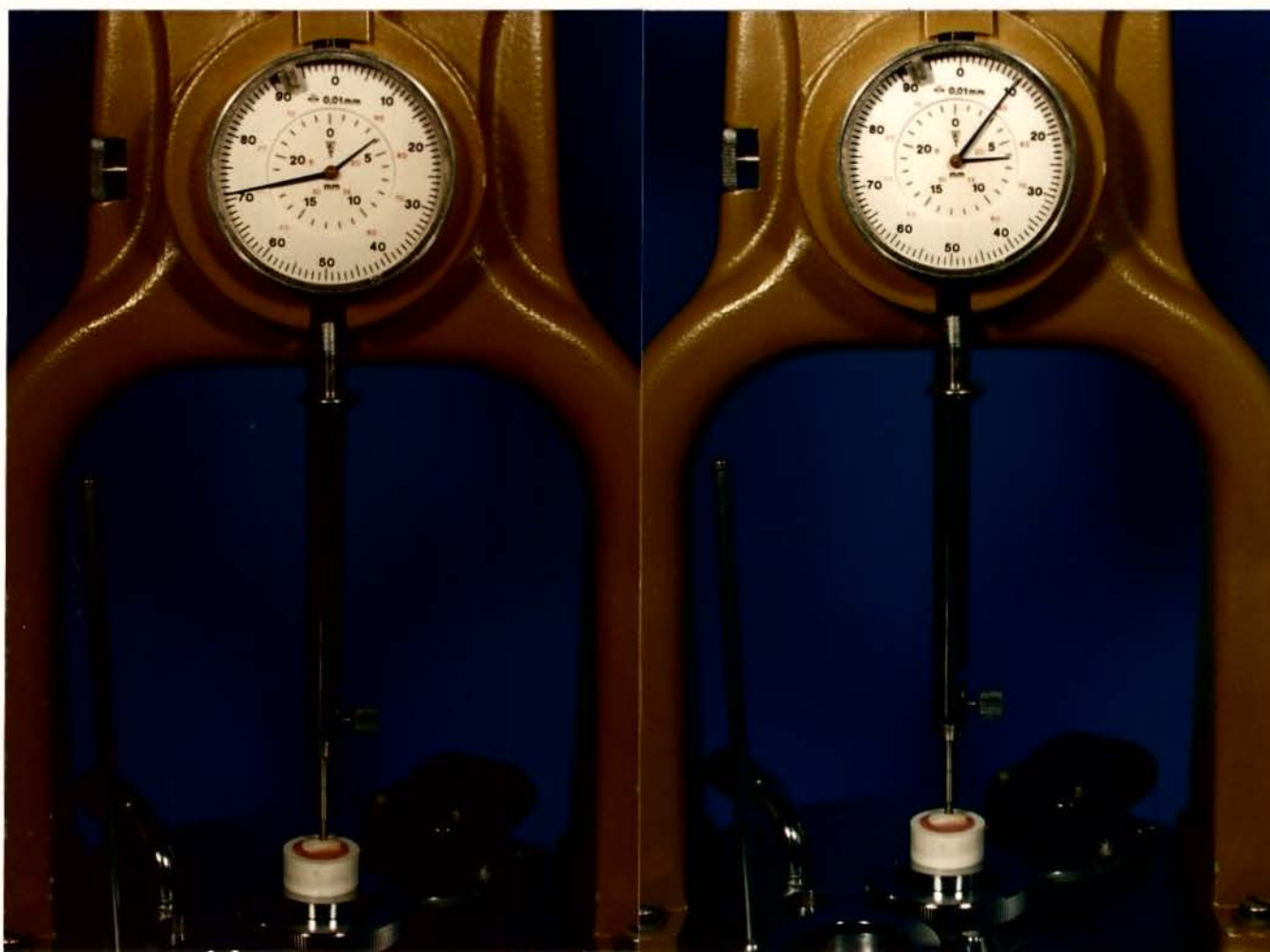
Figuras 4.5A e 4.5B - Ensaio de flexão, Consistômetro indicando, em milímetros, a leitura inicial da flexão (A) e a leitura após a estabilização (B).
