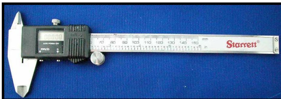
Figura 2: Paquímetro digital usado para realização das medidas.
