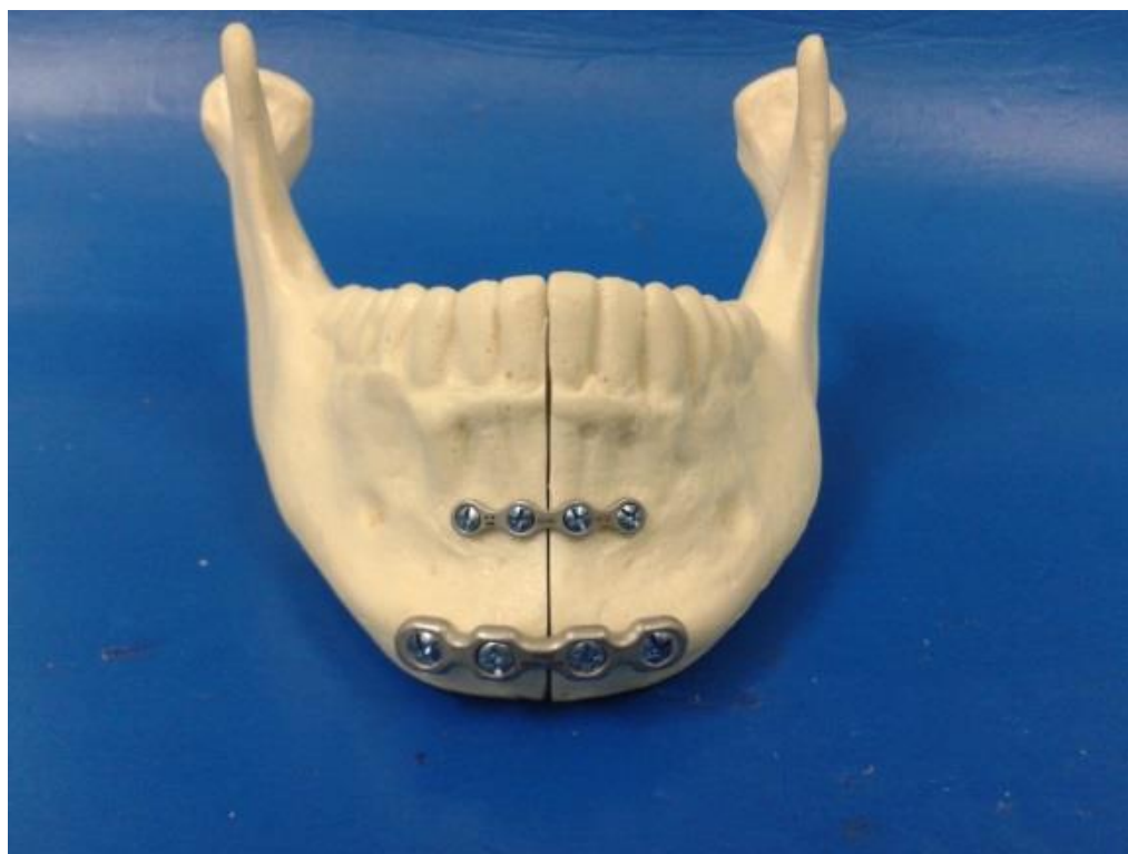
Figura 6 – Mandíbula fixada com uma placa do sistema 2,0 mm e outra placa do sistema 2,4 mm conforme descrito no grupo (PLL).
