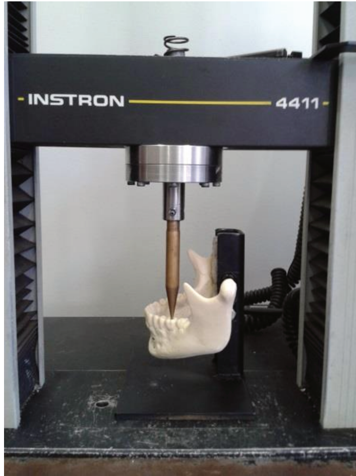
Figura13 – Mandíbula posicionada perpendicularmente à ponta do dispositivo de carregamento na máquina de ensaio mecânico.
