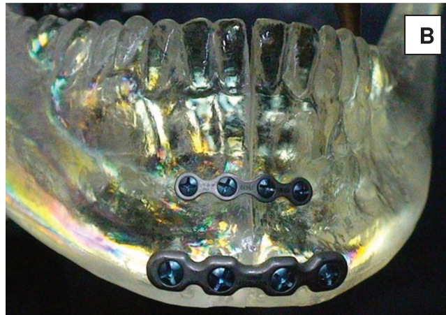
Figura 18 – Fotografia do teste fotoelástico no grupo (PLL). (A) antes do deslocamento; (B) após o deslocamento de 5 mm.
