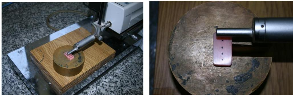
**Figura 12- Agulha do rugosímetro em posição transversal à direção dos movimentos lineares de escovação.**
