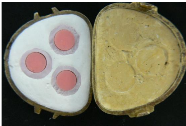
Figura 2 – Demuflagem dos corpos-de-prova.
