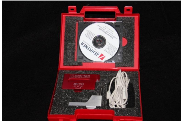
Figura 8 – Medidor de Brilho ZGM 1120 Glossmeter Kit
