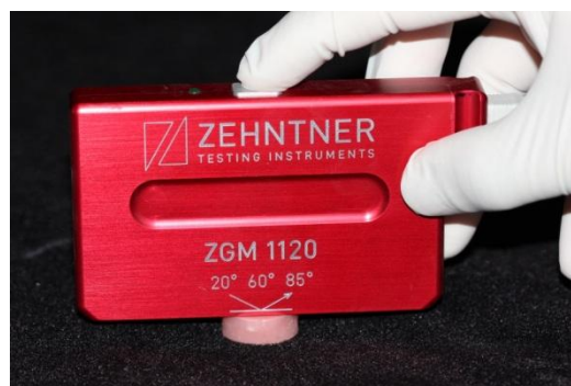
Figura 10 – Medidor de brilho posicionado sobre o corpo-de-prova durante a leitura.
