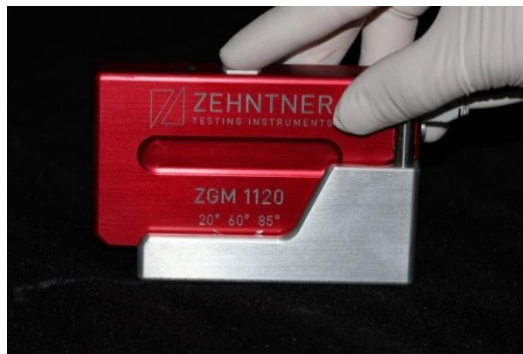
Figura 9 – Medidor de brilho acoplado ao calibrador.
