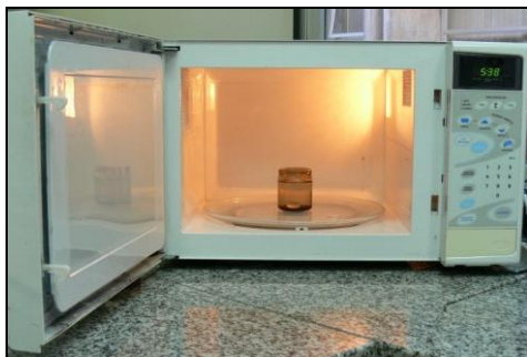
Figura 3 – Corpo-de-prova imerso em água e posicionado no forno de micro-ondas.
