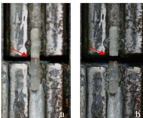
Figura 10- Ilustração da realização do ensaio de tração. A fixação do corpo-de-prova em dispositivo apropriado e o conjunto posicionado na máquina de ensaio universal. A seta destaca a posição do palito. B. após a realização do ensaio e fratura do palito. A seta destaca a área fraturada.
