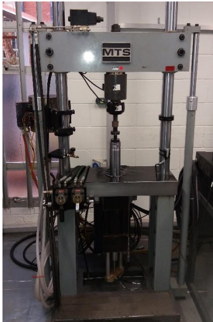
Figura 4. 7. Máquina universal de testes utilizada nos ensaios de compressão mecânica.
