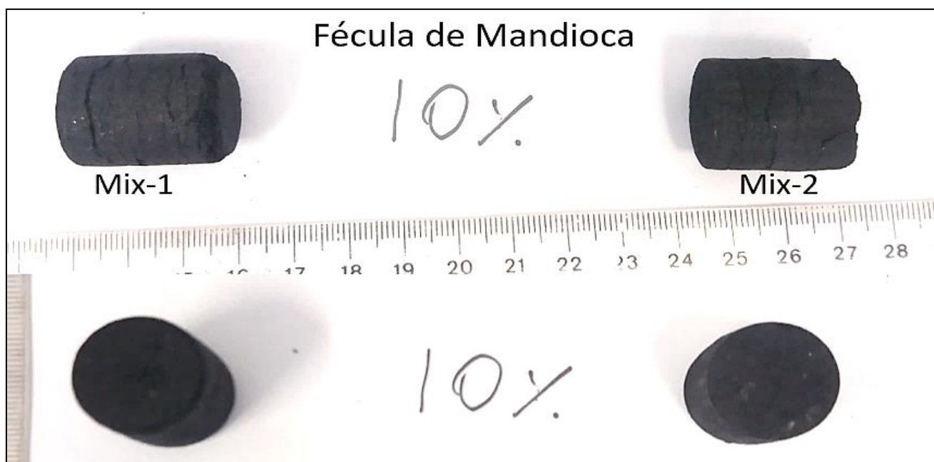
Figura 5. 14. Briquetes de carvão vegetal produzidos com 10% de FMC para ambas as misturas.
