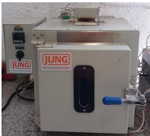
Figura 4. 2. Mufla utilizada na carbonização de bagaço de laranja.
