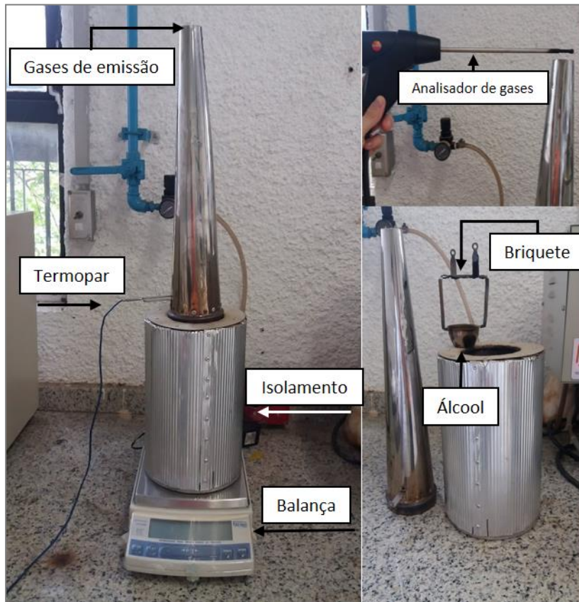
Figura 4. 8. Dispositivo-teste para a determinação do perfil de combustão.
