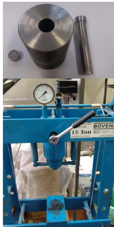
Figura 4. 4. Molde cilíndrico e prensa hidráulica utilizados para produção dos briquetes de carvão vegetal.
