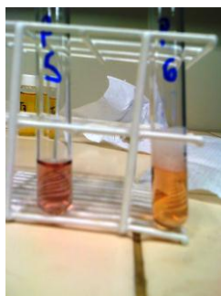
Figura 50. Testes após adição de eletrólito em amostra pura (P5) e estabilizada com 50% em volume de PVA a 4% (P6)
