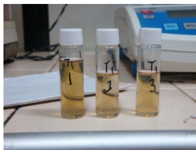
Figuras 31 (Esq) e 32 (Dir). Coloração das amostras T1 (Esq) e T2 (Dir) após 3 h de estocagem à temperatura de 5°C. A leve diferença de tonalidade nas mesmas amostras deve-se à adição de estabilizadores poliméricos
