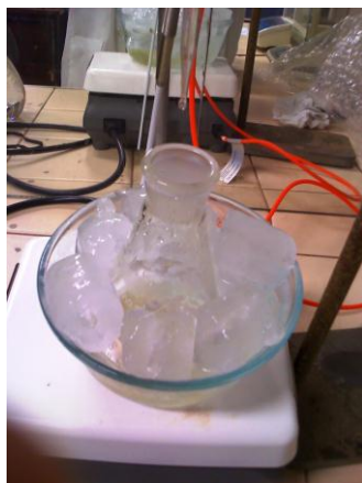
Figura 45. Esquema de gotejamento, agitação e resfriamento da síntese de nanopartículas de prata por redução por borohidreto de sódio.
