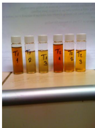
Figura 42. Aspecto das amostras puras e estabilizadas com polímeros após 90 dias da síntese com citrato de sódio. Amostras T1 (esq.) e T2 ( dir.) (as amostras T1 (1) e T2 (1), puras, mostram agregação em longo prazo)
