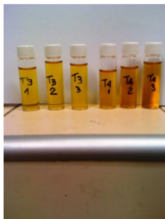
Figura 47. Aspecto da coloração dos colóides de nanopartículas de prata obtido pela redução por borohidreto de sódio. À esquerda obtidos por gotejamento de 1 gota/s (T3). À direita, obtidos com gotejamento acelerado. (T4)
