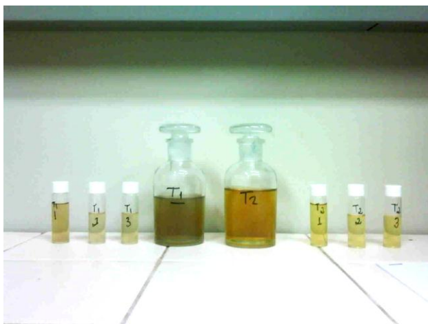
Figura 27. Comparativo de coloração de amostras sintetizadas sob aquecimento prolongado (T1 (esq.) e resfriamento imediato à temperatura ambiente logo após a mudança de coloração (T2) (dir.) A leve diferença de tonalidade nas mesmas amostras deve-se à adição de estabilizadores poliméricos
