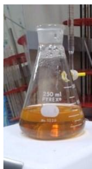
Figuras 29 (Esq) e 30 (Dir). Aspectos de colóides de prata nanométrica pelo procedimento 2 (esq) indicando agregação e procedimento 1 padrão (dir) com irrisória agregação das partículas
