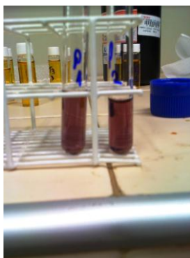
Figura 48. Aspecto de coloração de amostras de nanopartículas de prata com 2 gotas de \text{Na}_2\text{CO}_3 . à esquerda amostra pura (P1) e à direita amostra estabilizada com 50% em volume de PVP a 0,3% (P2). A coloração violácea indica forte agregação das partículas
