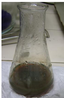
Figura 28. Agregação de partículas causada pelo prolongamento do aquecimento durante a síntese (40 min)
