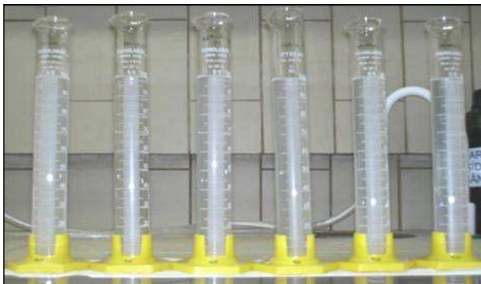
Teste de inchamento em água das bentonitas Vulgel O1, TEC-09 O1, Reminas O1, Soleminas Dye-10 O1, Bentogel Patag O1 e Brasgel PBS50 O1 (seqüência da esquerda para direita), registro do inchamento após agitação + 24 h de repouso
