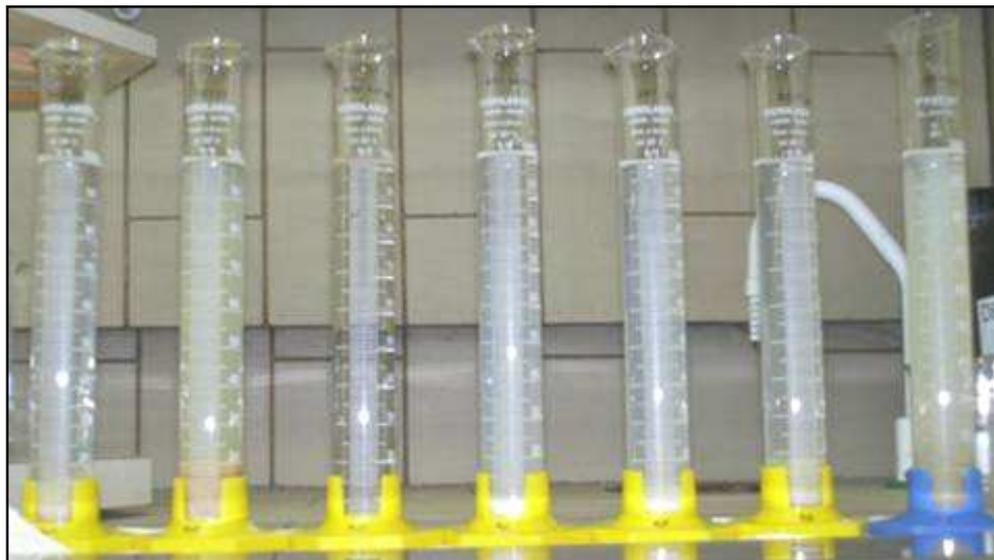
Teste de inchamento em água das bentonitas Vulgel, TEC-09, Reminas Natural, Reminas Sódica, Soleminas Dye-10, Bentogel Patag e Brasgel PBS50 (seqüência da esquerda para direita). Registro do inchamento após 24 horas de repouso sem agitação
