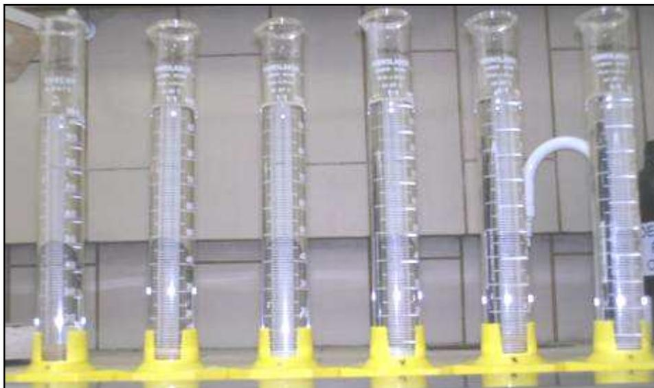
Teste de inchamento em xileno das bentonitas Vulgel O2, TEC-09 O2, Reminas O2, Soleminas Dye-10 O2, Bentogel Patag O2 e Brasgel PBS50 O2 (seqüência da esquerda para direita), registro do inchamento após 24 h de repouso sem agitação
