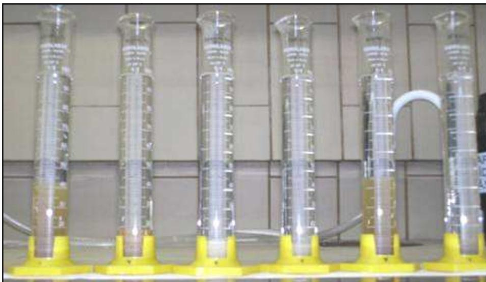
Teste de inchamento em xileno das bentonitas Vulgel O1, TEC-09 O1, Reminas O1, Soleminas Dye-10 O1, Bentogel Patag O1 e Brasgel PBS50 O1 (seqüência da esquerda para direita), registro do inchamento após agitação + 24 h repouso
