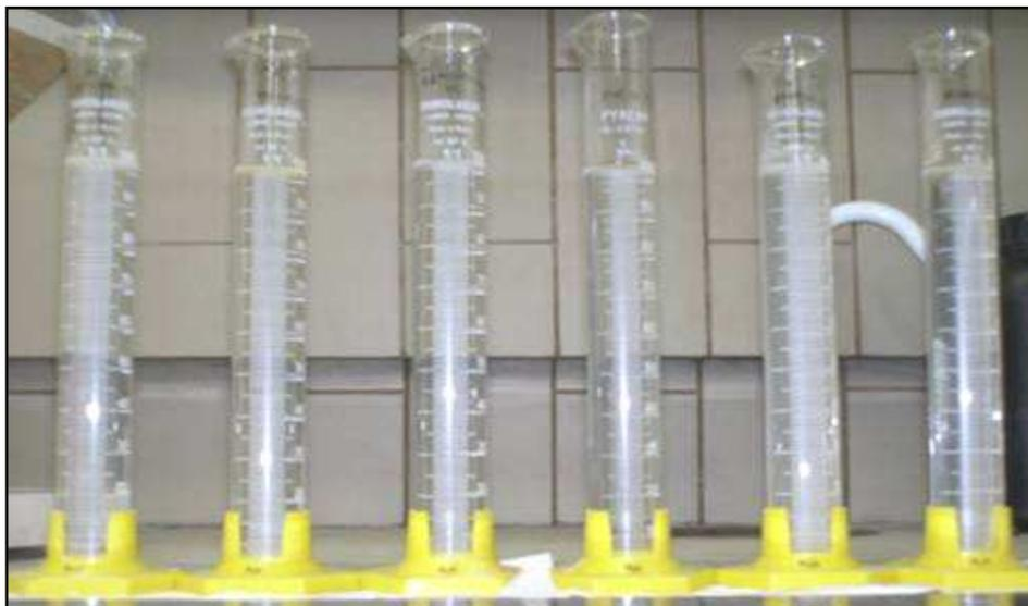
Teste de inchamento em água das bentonitas Vulgel O1, TEC-09 O1, Reminas O1, Soleminas Dye-10 O1, Bentogel Patag O1 e Brasgel PBS50 O1 (seqüência da esquerda para direita), registro do inchamento após 24 h de repouso sem agitação
