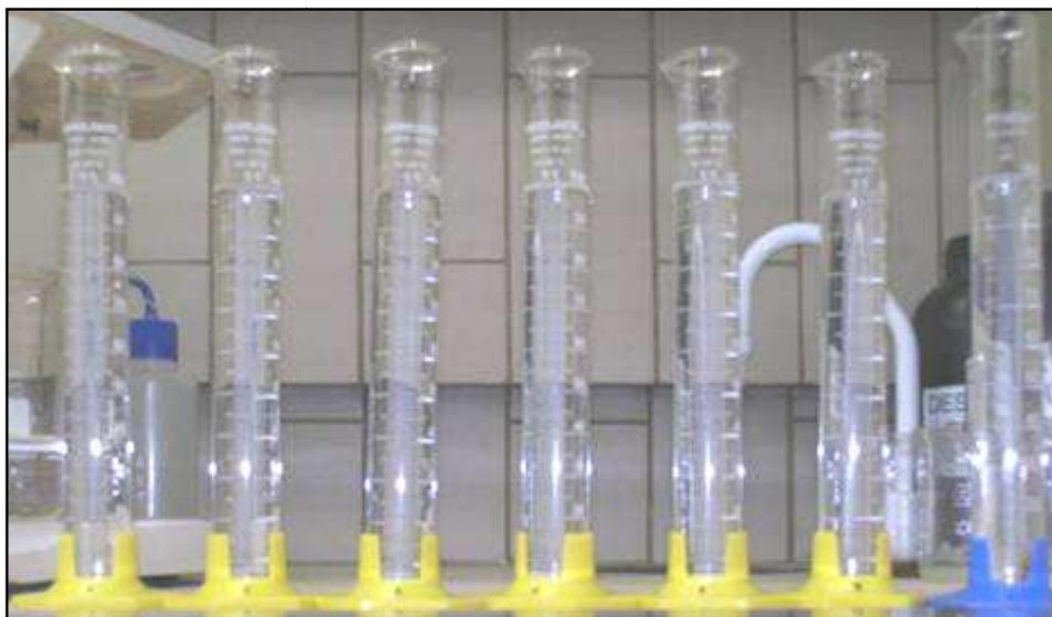
Teste de inchamento em xileno das bentonitas Vulgel, TEC-09, Reminas Natural, Reminas Sódica, Soleminas Dye-10, Bentogel Patag e Brasgel PBS50 (seqüência da esquerda para direita). Registro do inchamento após agitação + 24 horas repouso
