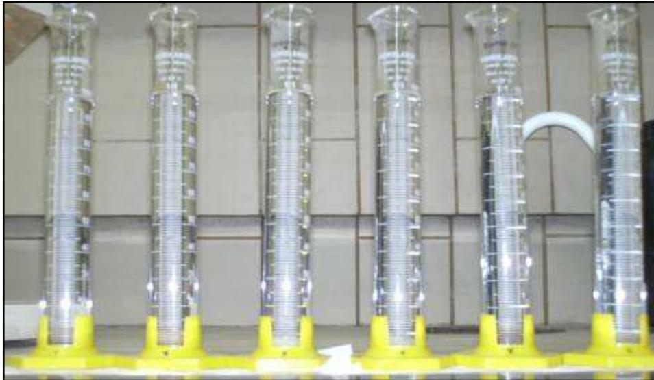
Teste de inchamento em xileno das bentonitas Vulgel O1, TEC-09 O1, Reminas O1, Soleminas Dye-10 O1, Bentogel Patag O1 e Brasgel PBS50 O1 (seqüência da esquerda para direita), registro do inchamento após 24 h de repouso sem agitação
