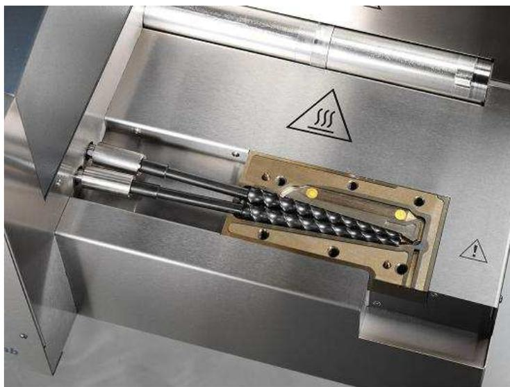
Figura 3.6 - Roscas da microextrusora HAAKE MiniLab II
