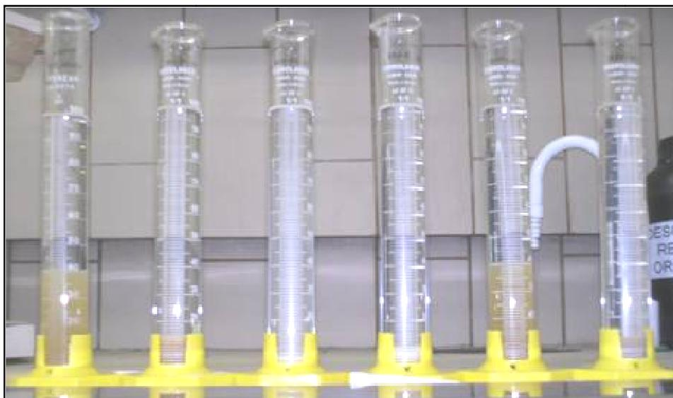
Teste de inchamento em xileno das bentonitas Vulgel O2, TEC-09 O2, Reminas O2, Soleminas Dye-10 O2, Bentogel Patag O2 e Brasgel PBS50 O2 (seqüência da esquerda para direita), registro do inchamento após agitação + 24 h repouso
