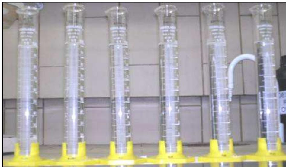
Teste de inchamento em água das bentonitas Vulgel O2, TEC-09 O2, Reminas O2, Soleminas Dye-10 O2, Bentogel Patag O2 e Brasgel PBS50 O2 (seqüência da esquerda para direita), registro do inchamento após 24 h de repouso sem agitação
