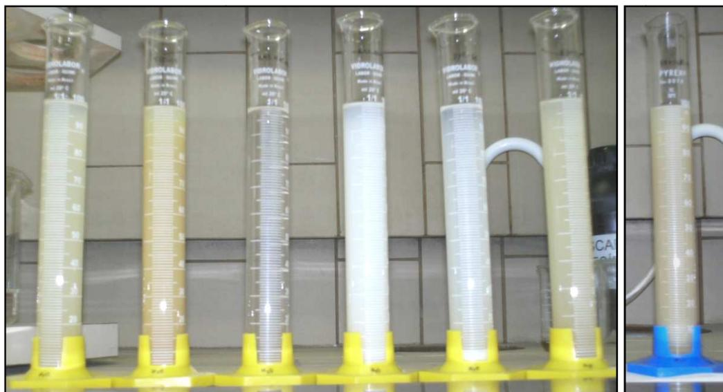
Teste de inchamento em água das bentonitas Vulgel, TEC-09, Reminas Natural, Reminas Sódica, Soleminas Dye-10, Bentogel Patag e Brasgel PBS50 (seqüência da esquerda para direita). Registro do inchamento após agitação + 24 horas repouso
