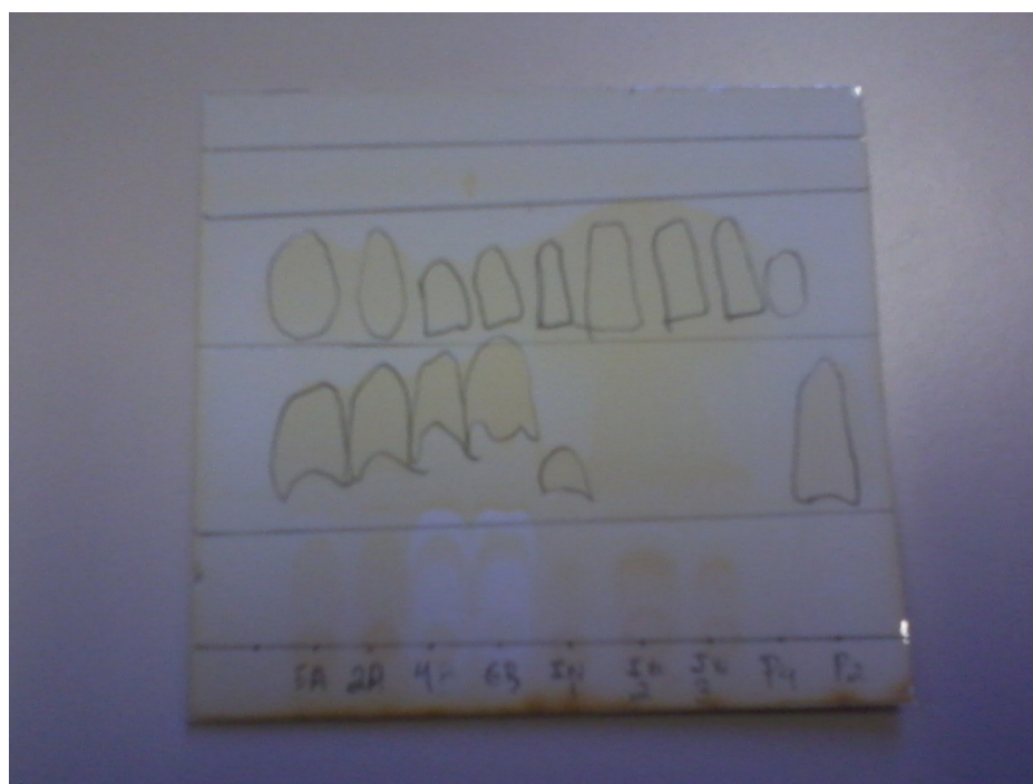
Figura 15. 5A E 2A: Amostra extraída por Bligh Dyer (2% H_2SO_4 á 70 ° C); In situ 1,2e 3 transesterificação in situ 70°C com 100% H_2SO_4 P 2 : Padrão ácido oleico; P 4 : Padrão de metil heptadecanoato.
