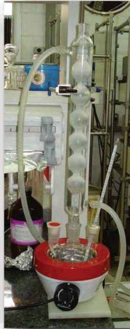
Figura 14: Procedimento para testes de dissolução e fluidização do PET.
