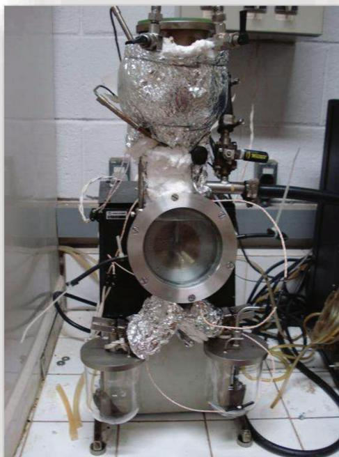
Figura 16: Destilador molecular após modificação para realização dos testes com PET.
