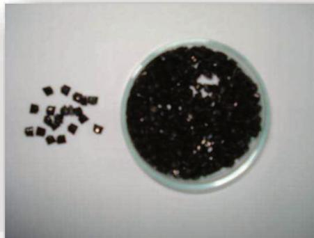
Figura 12: Resina de PET virgem preta utilizada na fabricação de fibras.
