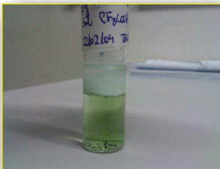
Figura 18: Amostra precipitada com álcool etílico.
