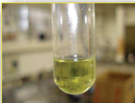
Figura 19: Amostra de ácido trifluoracético + corante
