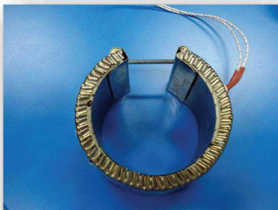
Figura 15: Resistência utilizada para aquecer a alimentação.
