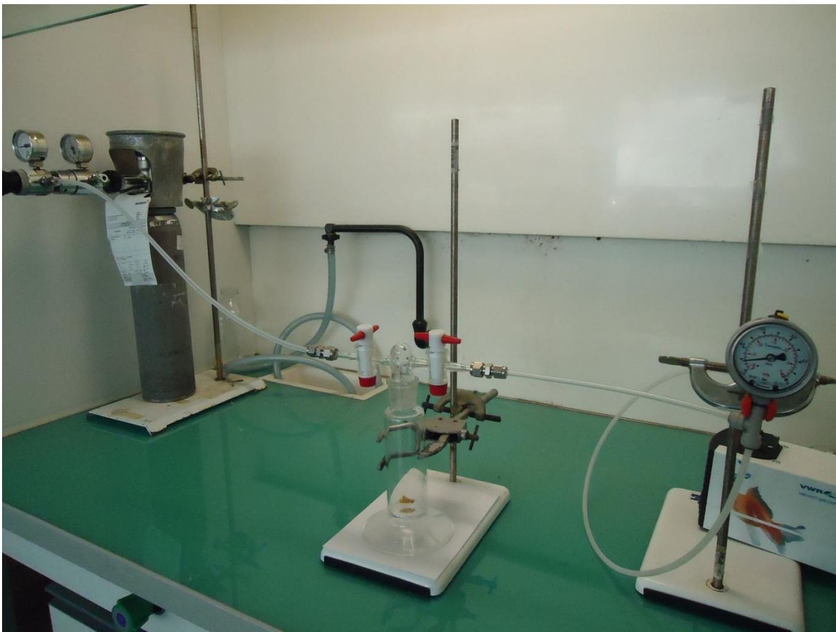
Figura 6. Sistema fechado construído para exposição do sensor a uma concentração controlado do gás H 2 S.
