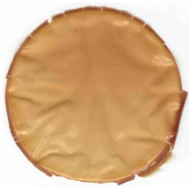
Figura 11. Imagem do filme inteligente contendo como indicador colorimétrico o \text{FeSO}_4 .
